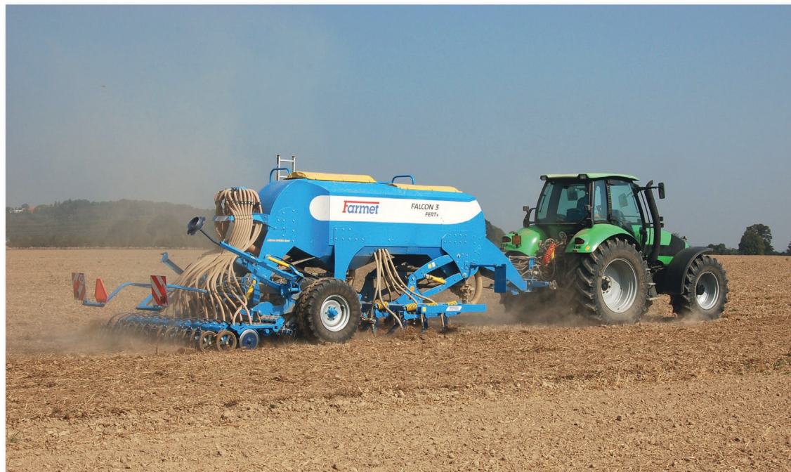
► Modulární secí stroj Falcon PRO je vhodný do minimalizačních i klasických technologií, pro setí po orbě, podmyčce, do mulče i bez přípravy
