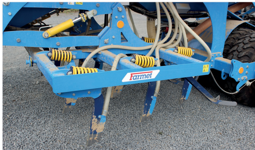
► Přihnojovací dlátová sekce s roztečí 250 mm je integrována do třířadé předzpracující strip-till sekce
