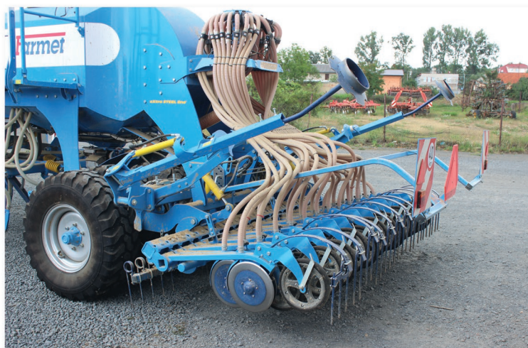
► Falcon PRO je osazen dvoudiskovými secími botkami s roztečí 125 mm
