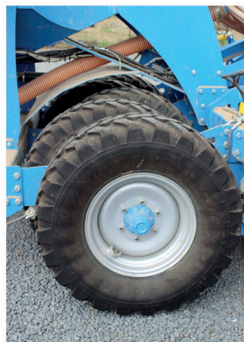
► Pneumatikový pěch má mimořádně uložená kola
