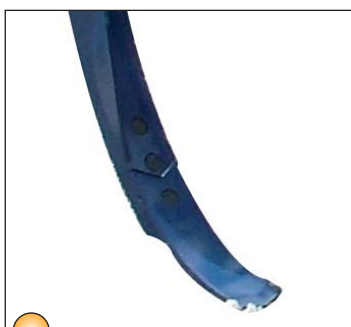
Dlátó bez křidélek umožňuje velmi hluboké prokypření až do hloubky 35 cm s nízkým tahovým odporem
