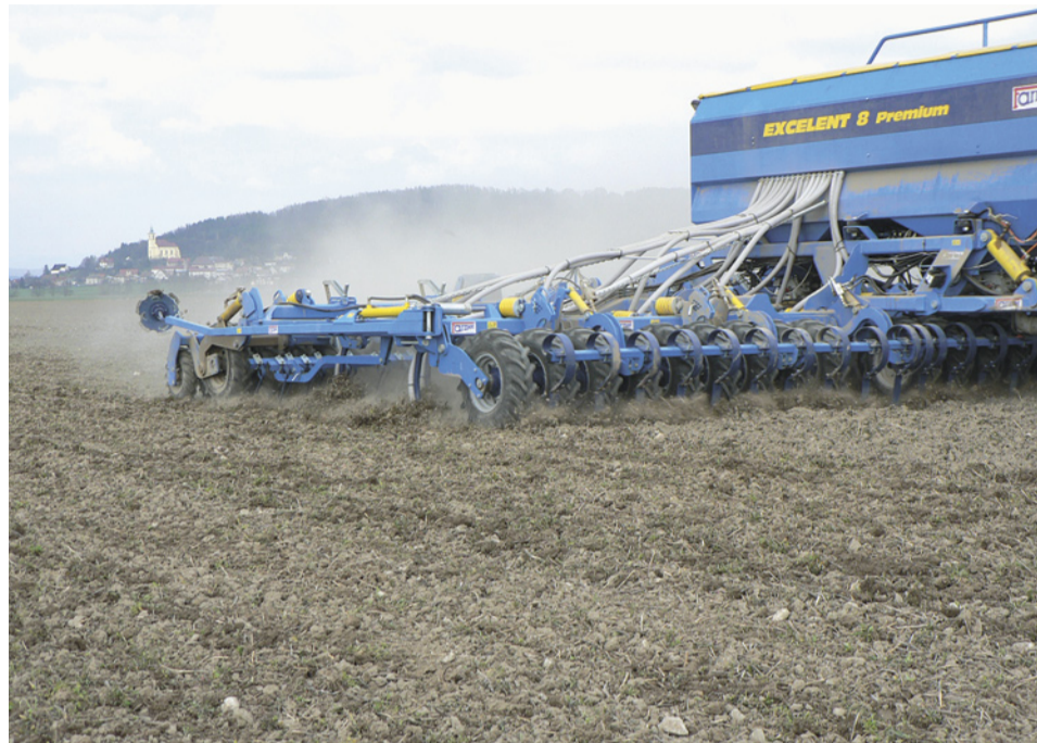
Pneumatikový válec a prstový smyk výborně zpracuje půdu a podrtí více než 90% hrud.
