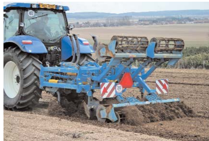
▼ Po sklopení bočních sekcí se pracovní záběr, a tedy i tahový odpor zmenší, čímž lze naplno využít tahový výkon pro kypření do hloubky 35 cm
