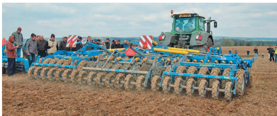
Výraznou pozornost a zájem vzbudil na polním předvádění nový diskový podmičák Diskomat. Jeho zadní část tvoří dvojitý pneumatikový válec s integrovanou nápravou, což optimalizuje rozložení hmotnosti stroje při práci. Válec je velmi odolný proti ucpávání a zalepování
