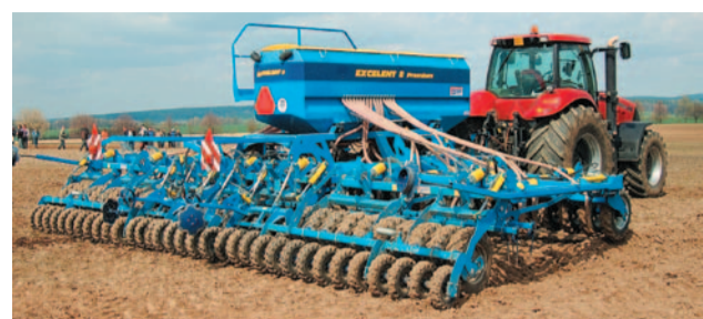
Radličkový secí stroj Excelent Premium umožňuje aplikaci hnojiva k osivu při seti
