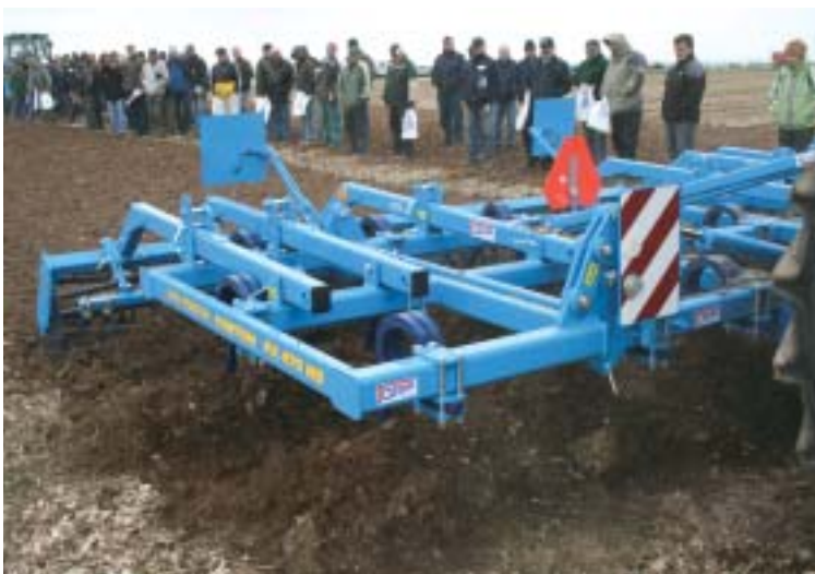
Fantom FX 470 NS je hydraulicky sklopný na přepravní šířku 300 cm. Má radlice, u nichž lze měnit rozteč na 23 nebo 27 cm
