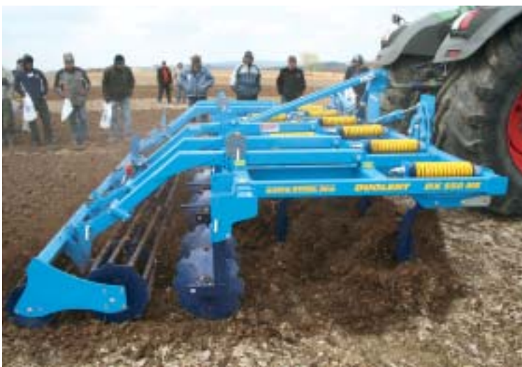
Radlice dlátového kypřiče Duolent jsou jistěny silnou pružinou s odjišťovací silou na hrotu 450 kg
