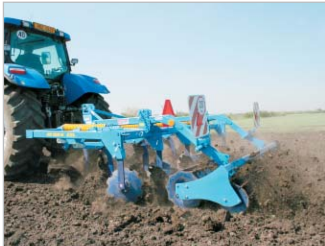
Nesený radličkový podmičák pro hlubší zpracování půdy vhodný pro menší podniky
