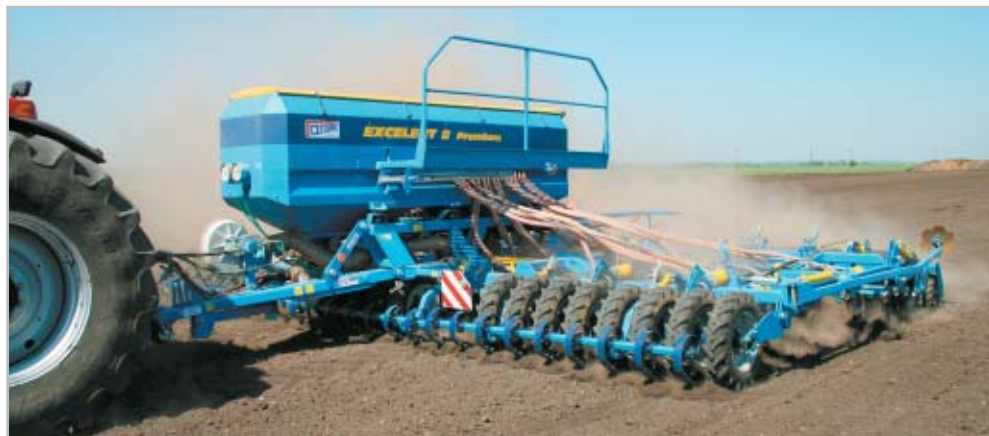
Secí stroj Excelent 8 Premium patří mezi stroje s nejmenším tahovým odporem ve své kategorii
