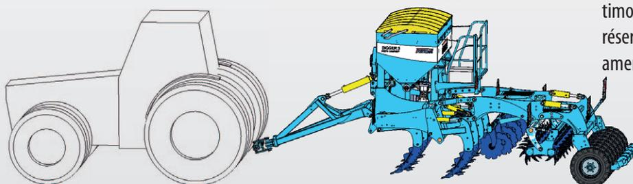
**Digger N-P Fert+ COMPACT** | timon et rouleau arrière pneumatique, réservoir d'engrais intégré, amendement en 2 horizons
