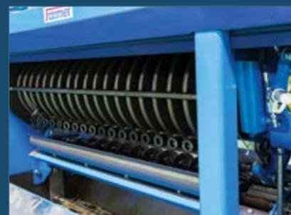
■ Prensas de la serie FS permiten alta variabilidad de uso. El corazón de la prensa es la geometría del prensado de múltiples niveles. Cambiando la forma del husillo ocurre la presión del material dentro de la prensa cada vez más alta que conduce a una separación progresiva del aceite de las semillas. El aceite entonces fluye a través de las aberturas en la prensa. Las láminas longitudinales permiten una mayor área de drenaje y por lo tanto se incrementa el rendimiento del aceite.
