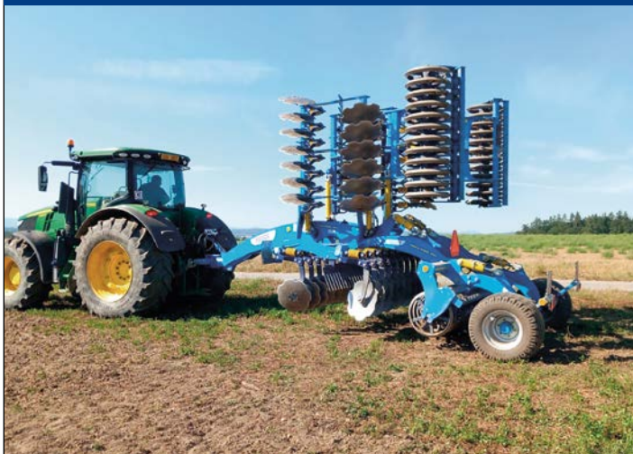
Sistema de plegado patentado transporte seguro por carretera
