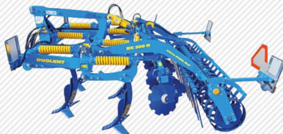
Variante avec réglage hydraulique de la profondeur de travail
