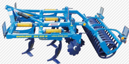
Вариант с механической регулировкой глубины обработки
