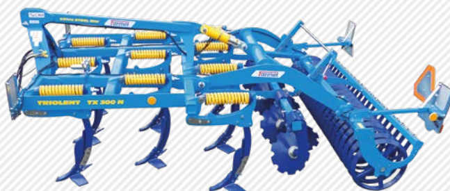
Вариант с гидравлической регулировкой глубины обработки
