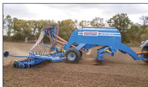
Высевающая планка с большой шириной обработки для высева культур с узкими междурядьями.
