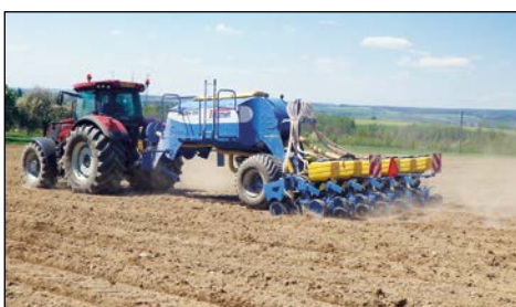
Függesztett szemenkénti vetőgéppel kombinációban.
