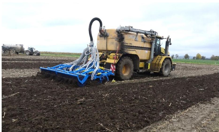
Obr. 56: Kromě výborného podpovrchového rozptýlení hnojiv nabízí nová řada aplikátorů také vysoce kvalitní zpracování půdy, a to i v podmínkách extrémního sucha nebo mokra (foto Farmet a.s.).
