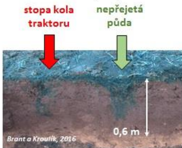
Obr. 8: Vliv stavu půdy na práci kypřících nástrojů.
