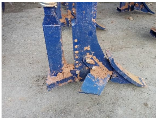
Obr. 40: Kypřicí radlice s aplikátorem kapalných hnojiv s širokou koncovkou rozptylovače se šíří dláta 75 mm pro systém zapravení do proudu zeminy (foto Brant).
