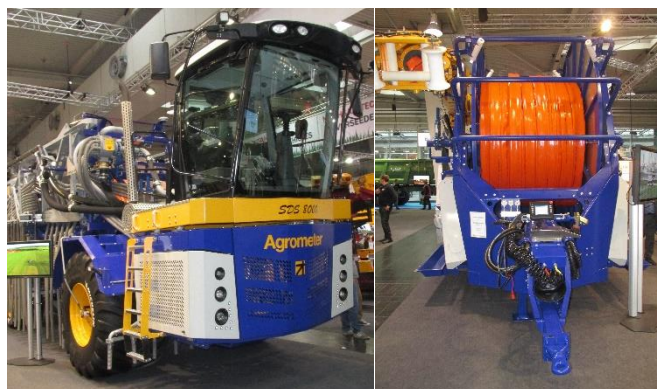
Obr. 6: Systémy vlečných transportních hadic lze využít u samohodných, tak tažených strojů (foto Brant).
