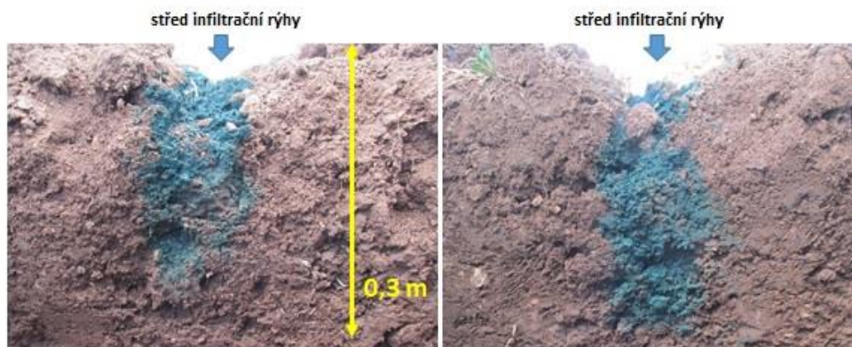
Obr. 34: Rozptyl kapaliny v infiltrační rýze 30 minut po aplikaci při dávce 30 a 60 m 3 /ha.
