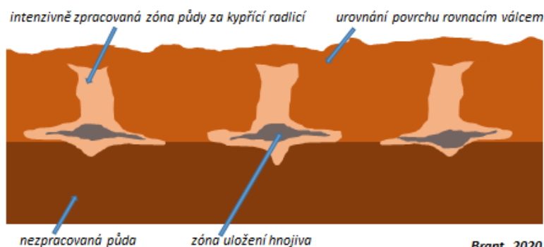
Obr. 39: Princip technologie pro horizontální tvorbu infiltračních zón s využitím aplikace do proudu zeminy.
