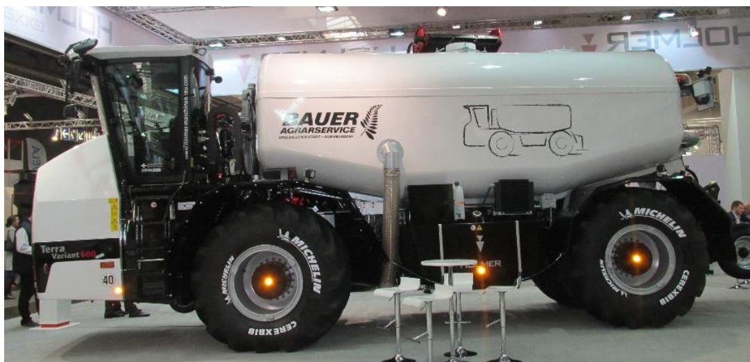
Obr 4: Snížení tlaku v pneumatikách a využití krabího chodu je jednou z možností eliminace utužení půdy (foto Brant).
