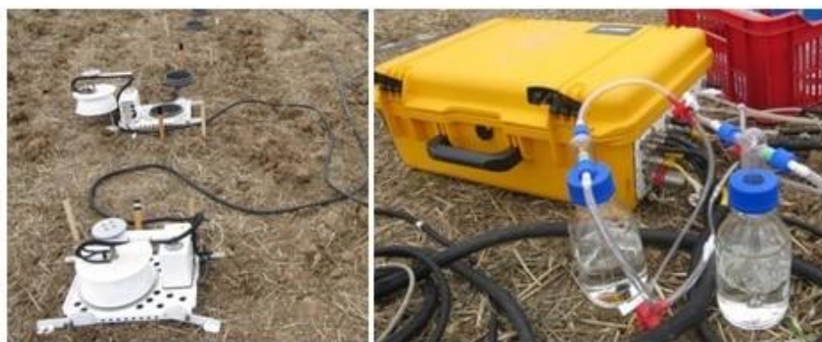
Obr. 86: Měření volatilizace amoniaku (foto Kusá).
