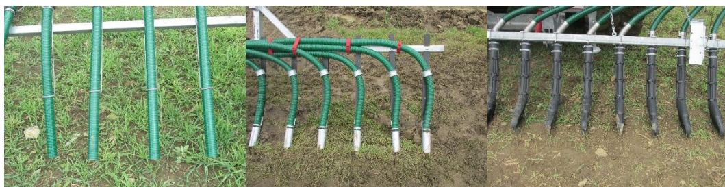
Obr. 15: Rozdílné způsoby zakončení hadicových aplikátorů pro povrchovou aplikaci tekutých hnojiv (foto Brant).
