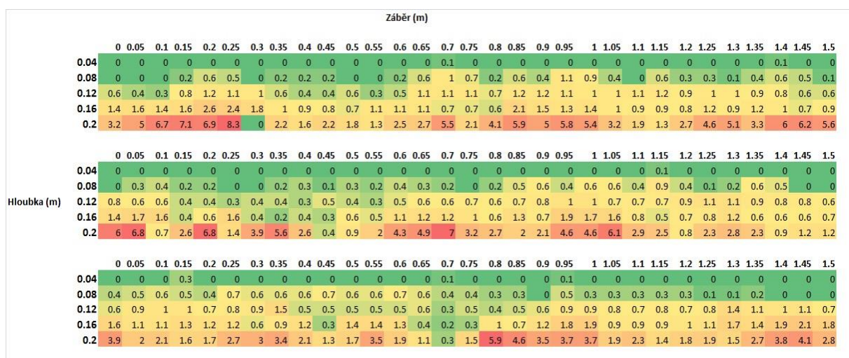
Obr. 67: Plošná aplikace, profil s hodnotami penetračního odporu do hloubky 0,2 m s krokem měření 0,04 m.
