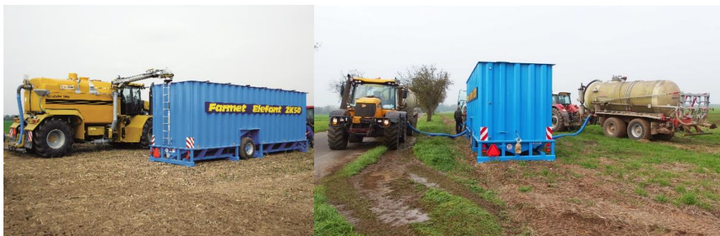
Obr. 12: Mezizásobníky tekutých hnojiv zvyšují nejen výkonnost pracovních linek, ale mohou přispět ke snížení počtu nepracovních jízd po pozemku (foto Farnet a.s.).
