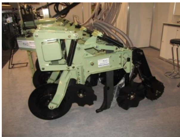
Obr. 24: Většina strojů pro aplikaci tekutých hnojiv vychází z koncepce aplikace hnojiva za kypřící radlici (foto Brant).
