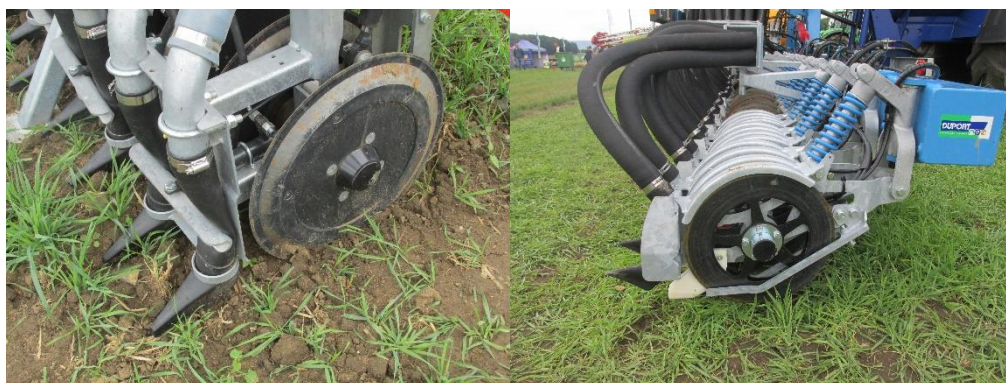
Obr. 19: Rýhovače pro tvorbu infiltrační rýhy pomocí disků nebo talířů (foto Brant).
