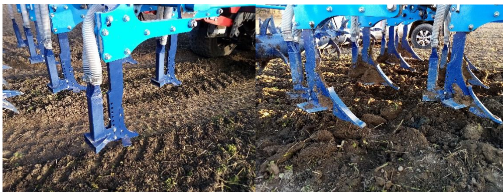
Obr. 43: Hodnoceny byly radlice se šířkou slupic 25 mm (vlevo) a 50 mm (vpravo) v kombinaci se širokými koncovkami (foto Brant).
