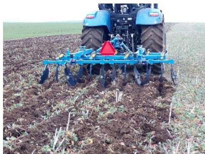
Obr. 59: Tvorba infiltračních rýh na strništi ozimé řepky před budoucím výsevem ozimé pšenice (foto Brant).
