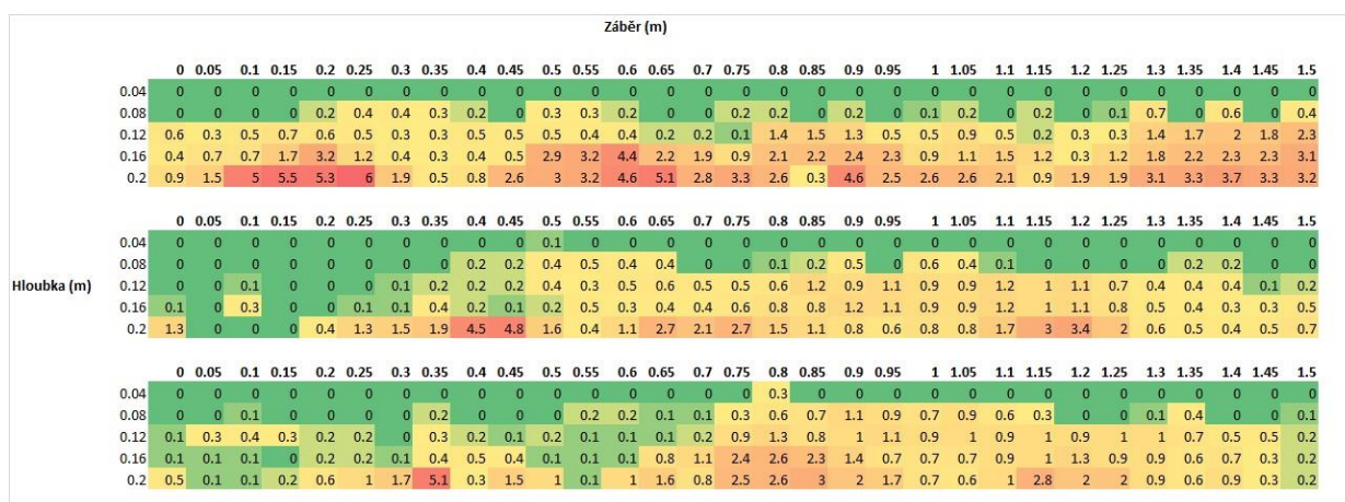
Obr. 68: Profil s vytvořenými infiltračními rýhami, profil s hodnotami penetračního odporu do hloubky 0,2 m s krokem měření 0,04 m.
