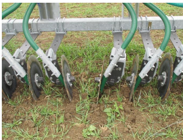
Obr. 20: Systémy otevření půdy pomocí šikmo postavených talířů (foto Brant).
