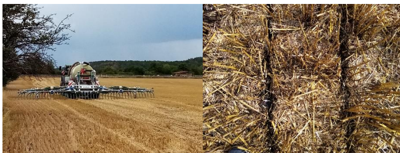
Obr. 18: Systém rýhovačů lze využít nejen pro přihnojení do vzešlých porostů obilnin, ale také k aplikaci na strniště (foto Brant).
