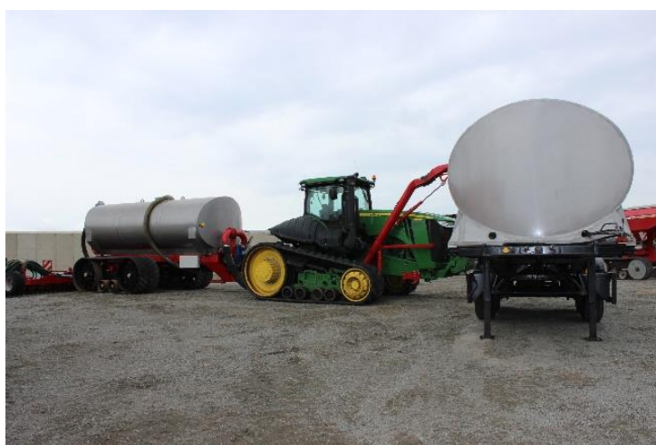
Obr. 5: Náhrada pneumatik u tažných prostředků a zásobníků tekutých hnojiv pásy (foto Kroulík).
