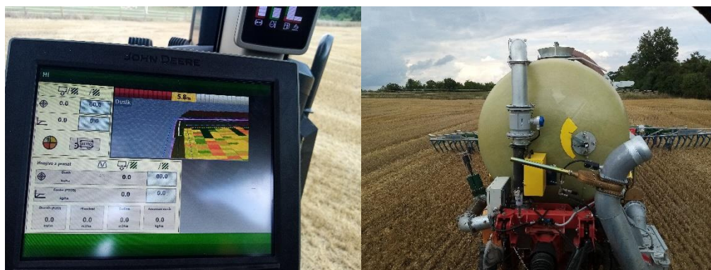
Obr. 27: Variabilní aplikace prasečí kejdy na základě aplikační mapy odběru dusíku (vlevo), vpravo je patné umístění NIR senzoru na aplikační cisterně (foto Brant).
