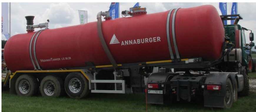
Obr. 13: Automobilové návěsy umožňují transport velkých objemů tekutých hnojiv a umožňují plnění nádrží aplikátorů z komunikace. Problémy však může činit jejich stání na komunikaci při přečerpávání hnojiv (foto Brant).
