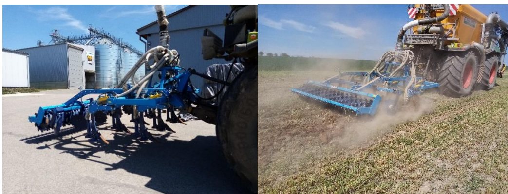
Obr. 83: V rámci testování byl ověřován prototyp stroje firmy Farnet a.s. pro aplikaci kapalných hnojiv do proudu zeminy (foto Brant).
