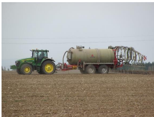
Obr. 14: Cílená povrchová aplikace pomocí hadicového aplikátoru (foto Brant).
