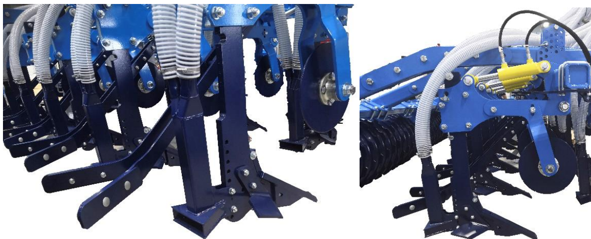
Obr. 57: Speciální kypřící radlice s dláty s velmi ostrým úhlem vnikání do půdy mají nízký tahový odpor a díky trhání půdy směrem nahoru zajišťují porézní zóny pro vsakování hnojiva. Hnojivo je rozptylováno speciálními rozstříkovými koncovkami do širokých pásů do hloubky 15 – 20 cm, přičemž při rozteči dlát 37,5 cm je hnojivo rozptýleno na více než 70 % plochy (foto Farmet a.s.).
