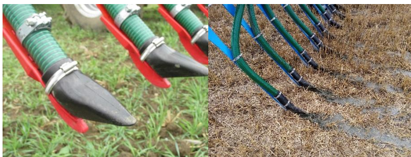
Obr. 17: Rýhovače umístěné přímo na aplikačních hadicích zakončených aplikační botkou (foto Brant).
