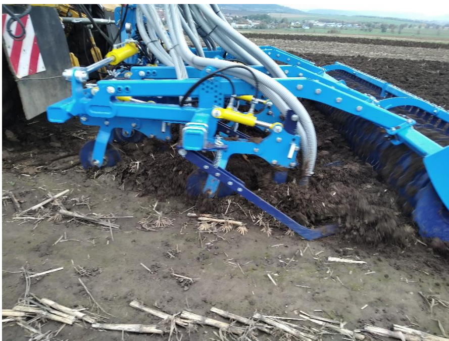
Obr. 58: Půda se před radlicemi rozevívá a za radlicemi se opět uzavírá, takže hnojivo je ihned zakryto, nešíří se zápach a jsou výrazně eliminovány emise \text{CO}_2 , \text{NH}_3 a \text{NO}_x (foto Farmet a.s.).
