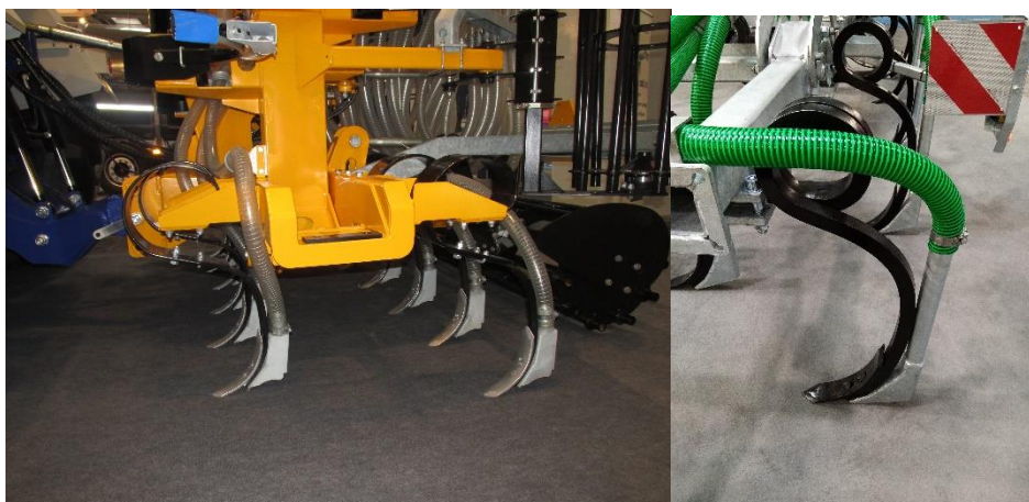
Obr. 22: Mělké či hlubší zapravení do půdy pomocí aplikačních dlát (foto Brant).
