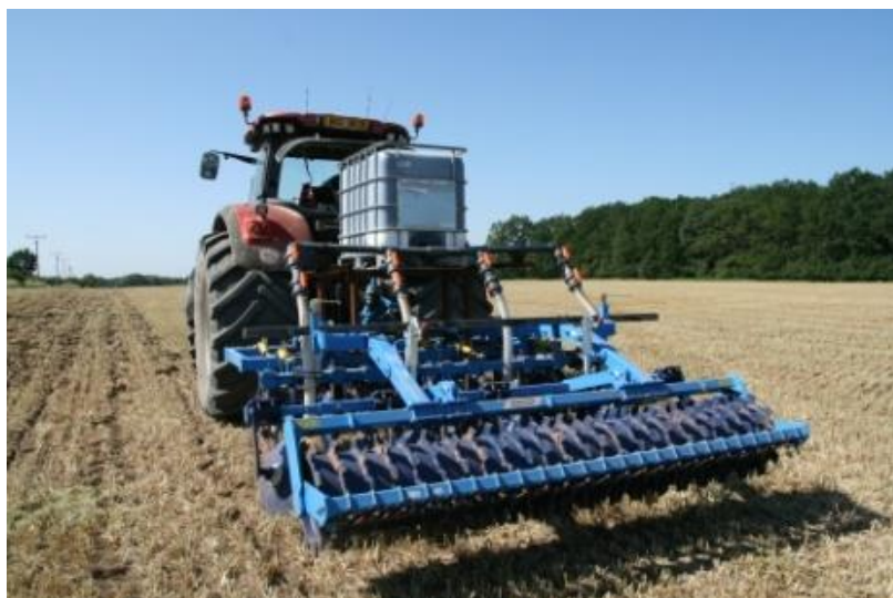
Obr. 47: Testovací stroj byl vybaven nádrží s roztokem obarvené vody (foto Brant).
