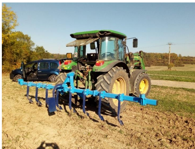
Obr. 29: Primárně byla pro tvorbu infiltračních rýh testována rozdílná dláta obdélníkového a lichoběžníkovitého tvaru s rozdílnou šířkou (foto Brant).
