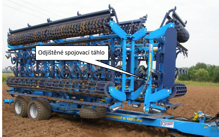
Obr.7-stroj K 1570 PS před zahájením rozklápění
