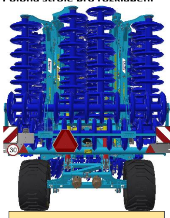
Obrázek 11 Poloha stroje pro rozklápění
