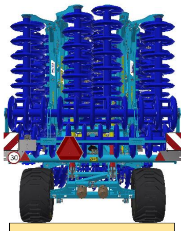
Abb. 11 Lage der Maschine zum Auseinanderklappen
