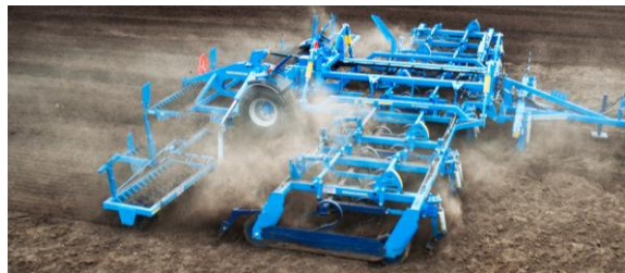
K1000PS с дробильными катками DV1000
