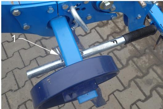
1 – Federstift entfernen und den Hebel aus der Lagerung ziehen
