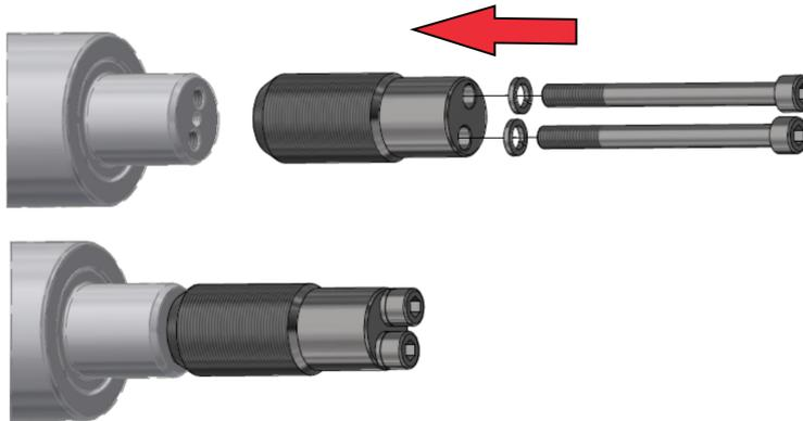
2. Aufsetzen des Lagers + Unterlegscheiben und Anschrauben des Vorrichtungskorpus
