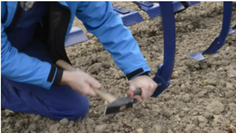
Mittels der Werkstattausstattung wird der Federsplint herausgeschlagen und danach kann die Schar von der Scharsäule abgezogen werden.
