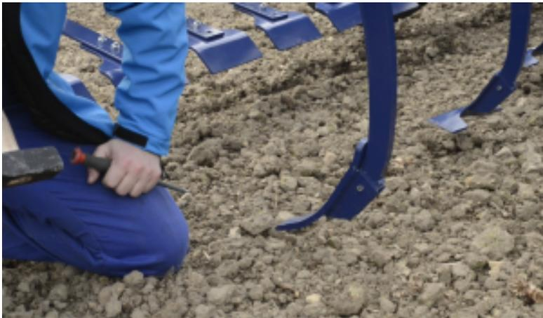
Die Maschine wird ausreichend ausgehoben, so dass sich das Arbeitsorgan von der Scharsäule abziehen lässt.
