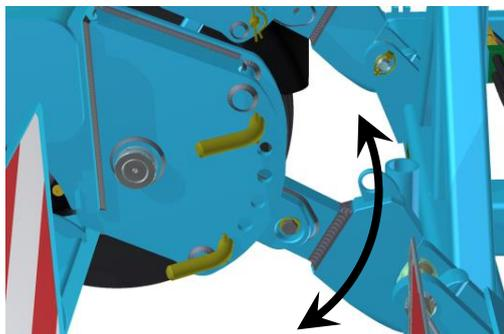
2. Durch die vollständige Entfernung der Stützstifte.
