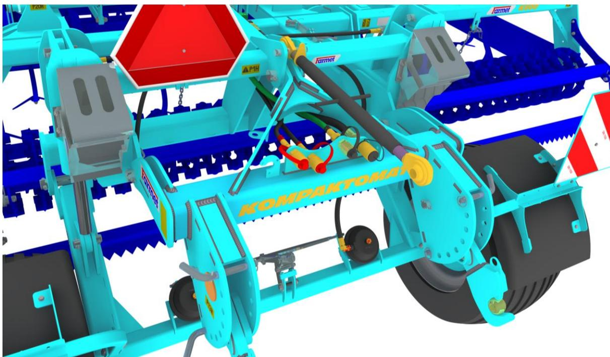
○ **KREISLAUF FÜR DIE STEUERUNG DER SPURREISER**
