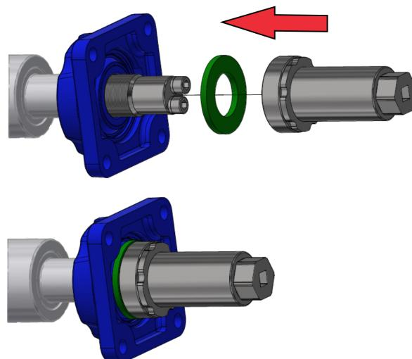
3. Montáž ložiska šroubováním těla přípravku pomocí klíče velikosti 36
