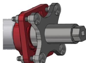
3. Demontáž ložiska šroubováním těla přípravku pomocí klíče velikosti 36
