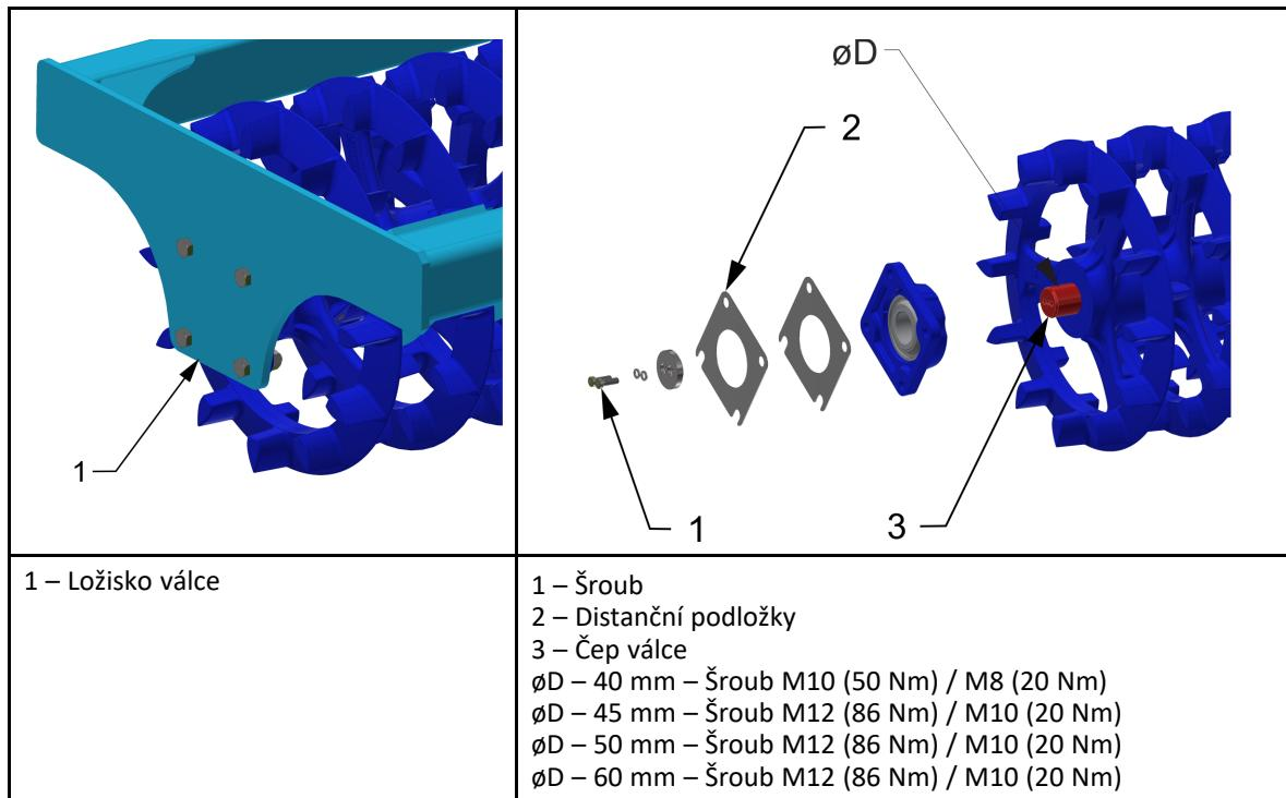
**10.1.1 Použití přípravku demontáže a montáže ložisek**
