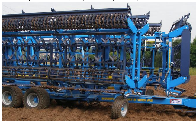
Рис. 16 - рабочая секция прижата к фиксаторам на шасси
