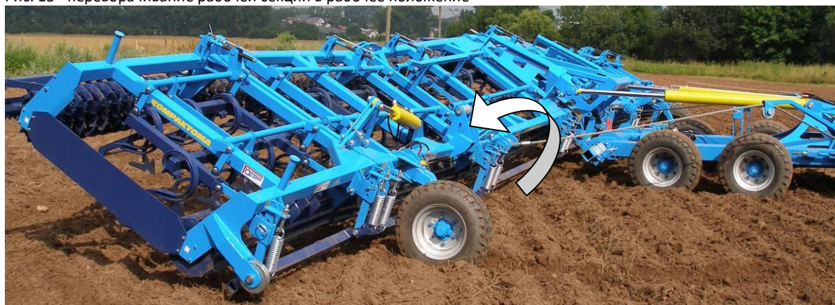
Рис. 13 - переворачивание рабочей секции в рабочее положение
