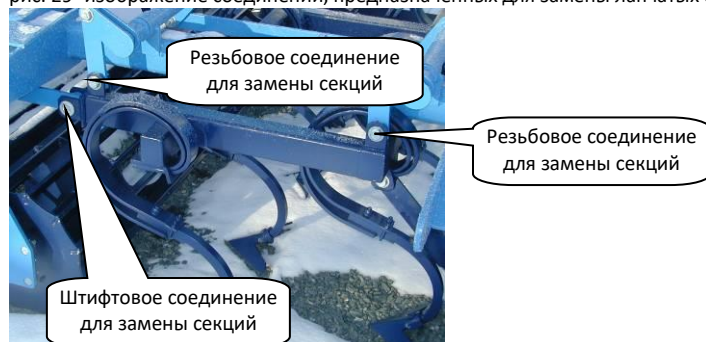
рис. 29- изображение соединений, предназначенных для замены лапчатых секций
