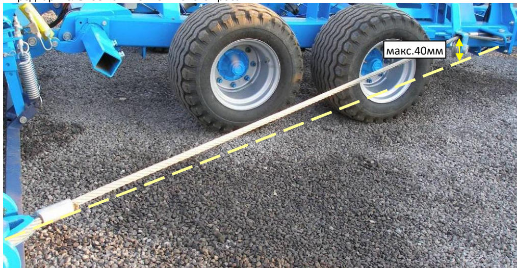
Рис. 24 - предварительное натяжение тягового троса
