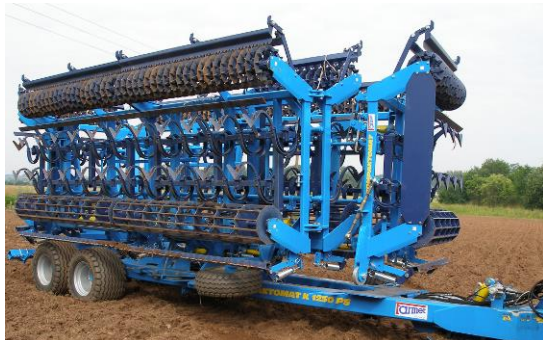
Рис. 9 - вспомогательные колёса в транспортном положении
