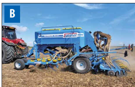
Siew rzepaku z głębokim spulchnieniem oraz aplikacją nawozów.
