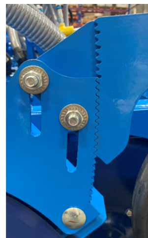
Absenkung der Drillschare um 4 cm.
