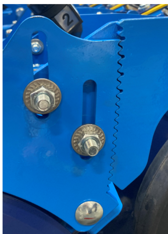
Absenkung der Drillschare um 1 cm.
