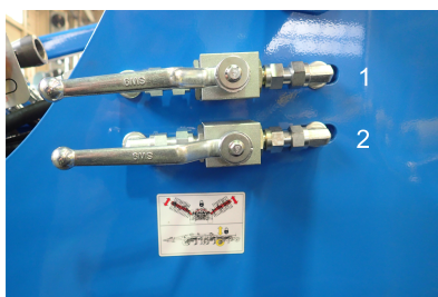
Рис.2 - запорные (шаровые) вентили
