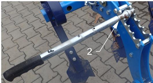
2 – Loger le levier sur le côté plus long de l'embout.
