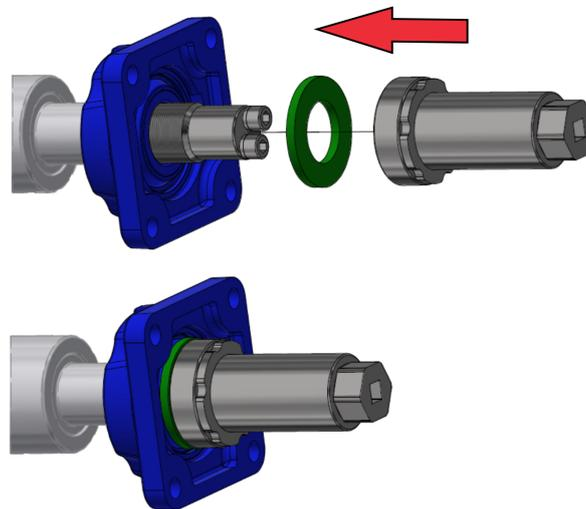
3. Montage du palier en vissant le corps du dispositif à l'aide de la clé 36
