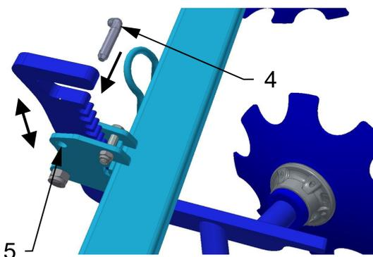
4 – Régler la hauteur demandée du disque et réinsérer l'axe
