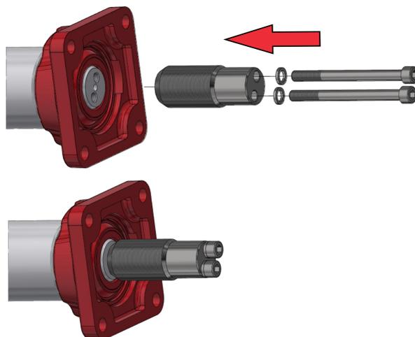
2. Vissage du corps du dispositif, mise en place de la pièce pour le démontage du palier et fixation au palier à l'aide des écrous
