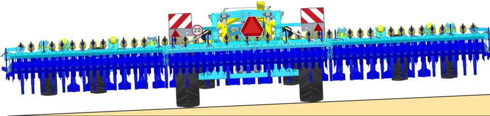
Position de la machine pour le dépliage
