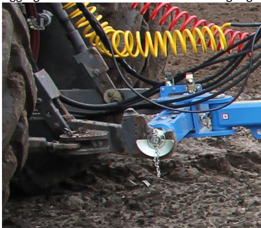
Aggregieren mit der hinteren TBZ-Aufhängung
