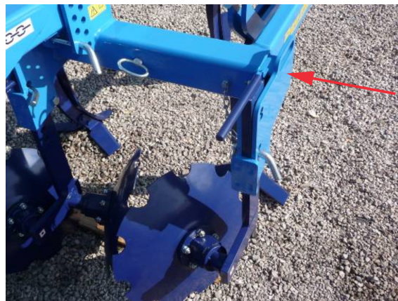
Abb. 4 - Seitliche, Ausrückbare Scheiben in Transportlage
