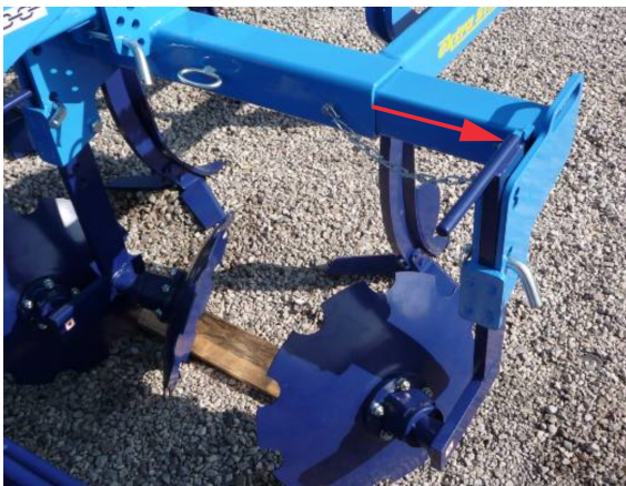
Abb. 5 - Hintere, doppelte Walze in Arbeitslage
