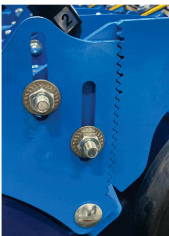
Zagłębienie redlic wysiewających o 1 cm.
