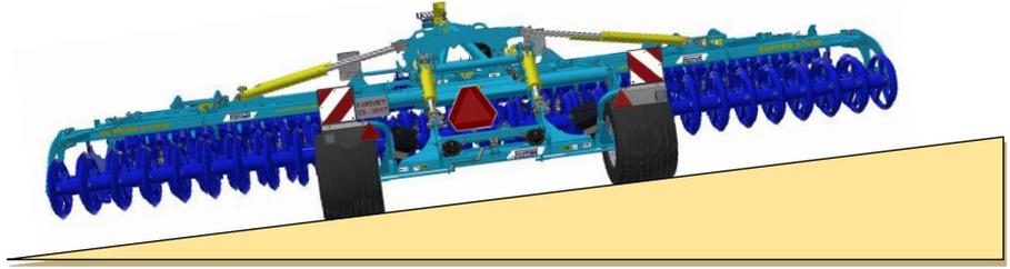
Figure 11 Position de la machine pour le dépliage
