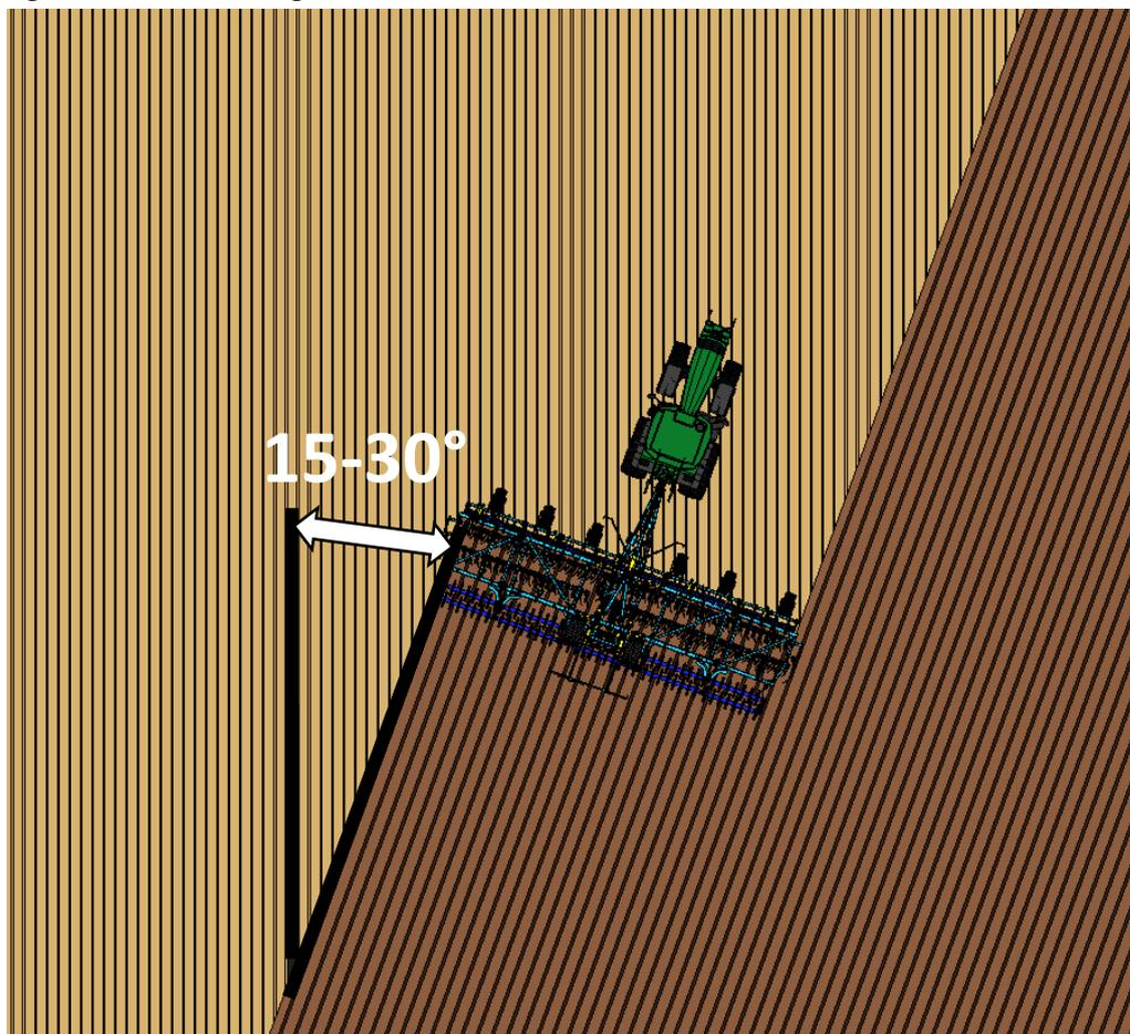
Le travail avec la machine dans le sens identique aux opérations précédentes (semis/récolte) peut engendrer le bourrage de la machine et réduire la qualité du travail et l'effet de nivellement de la machine.
