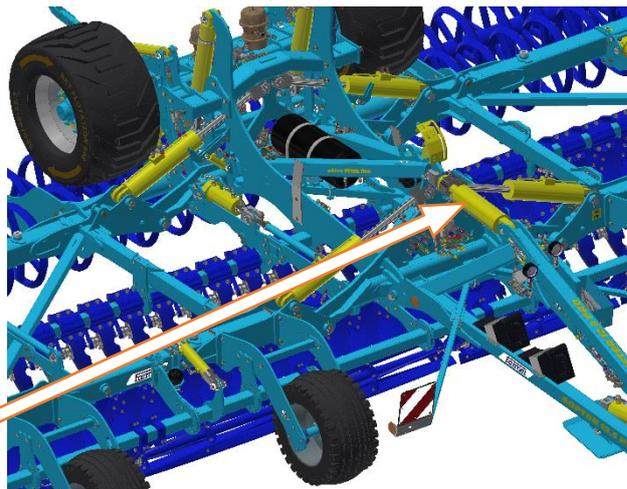
Figure 5 Valve sur la barre d'attelage
