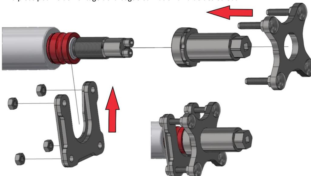
3 Démontage de la bague en vissant le corps du dispositif à l'aide de la clé 36
