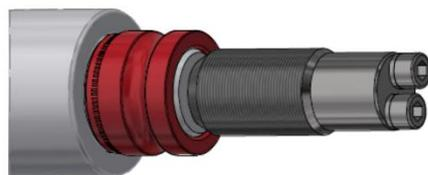
2 Vissage du corps du dispositif, mise en place de la pièce pour le démontage du palier, mise en place de la pièce pour le démontage de la bague et fixation à l'aide des écrous
