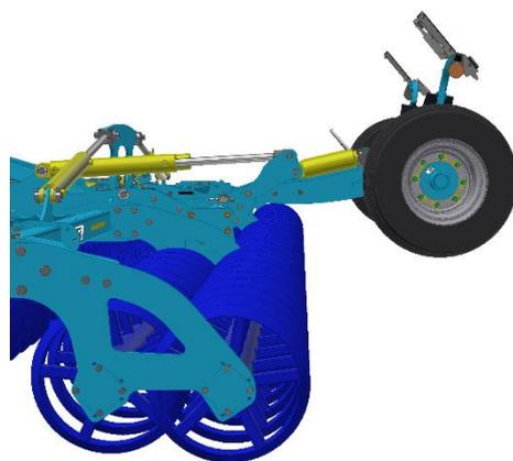
Figure 23 Position de l'essieu en tournant
