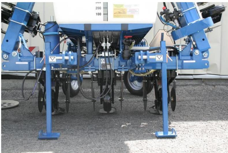
Рис. 2. Опорные ножки машины в положении хранения
