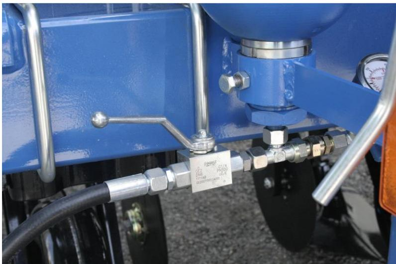
Рис. № 6 Вентиль гидравлического прижатия в открытом положении
