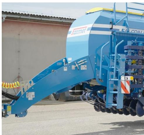
9. Con el mando de los brazos del tractor bajar toda la máquina hasta que se afloje el brazo superior.
