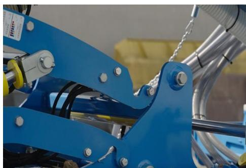
10. Desacoplar el sistema de acoplamiento rápido de las mangueras de fertilización adicional y la cadena de tender las mangueras.
