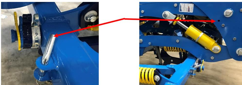
7. Con el mando del sistema hidráulico del tractor levantar la sección delantera hasta que se afloje el brazo inferior.
