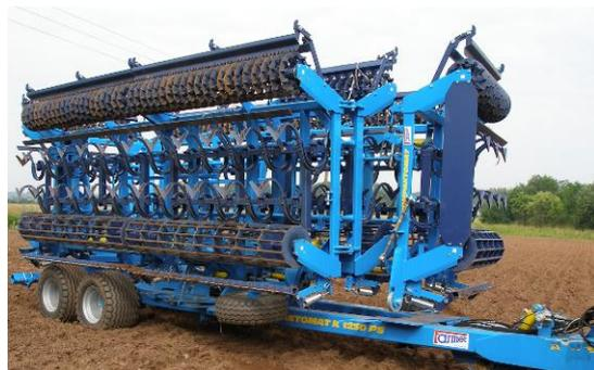
Рис. 10 - вспомогательные колёса подготовлены к раскладыванию машины
