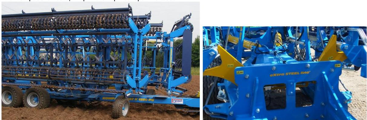
После складывания машины в транспортное положение зафиксируйте боковые рамы соединительной тягой и разместите предохранительные щитки в положения для транспортировки по наземным коммуникациям.
