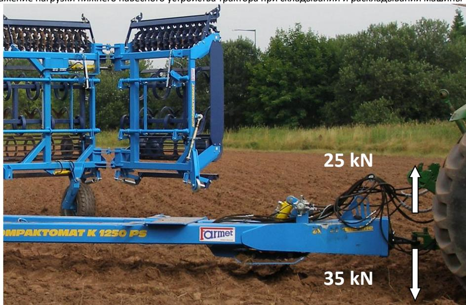
**7.2** Перед раскладыванием демонтируйте предупредительные щитки и закрепите их в креплениях на дышле. Раскладывайте и складывайте машину на достаточно большой и ровной поверхности. Если Вы находитесь на небольшом склоне, разместите сцепку машины с трактором так, чтобы она была направлена в направлении движения по склону вниз. При складывании трактор и машина должны быть заторможены, движение сцепки трактор-машина запрещено!
