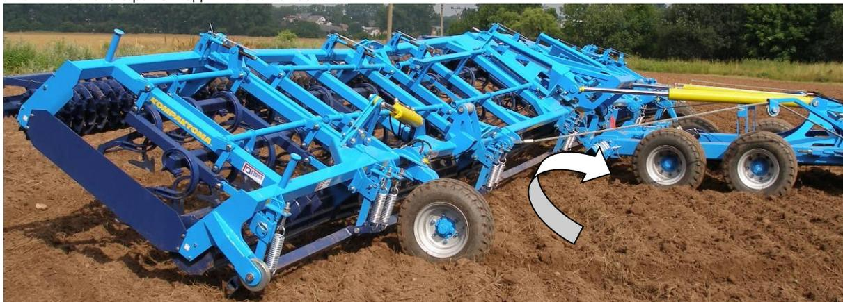
Рис. 15 - закрытие рабочих секций в транспортное положение
