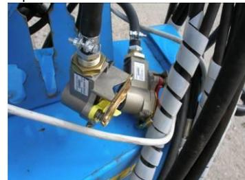
рис. 28 - деталь описания управления вентилем тормоза
