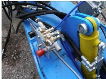
рис. 27 - быстроразъёмные муфты тормоза
