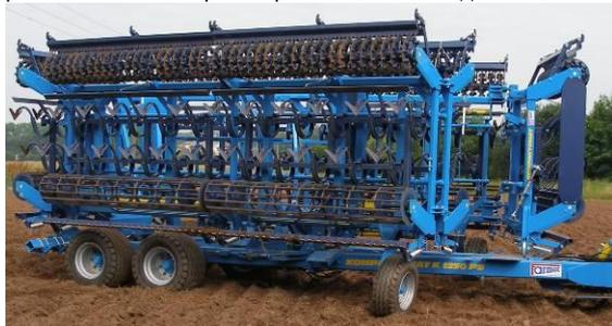
рис. 31 - положение рабочей секции для замены лап в поле
