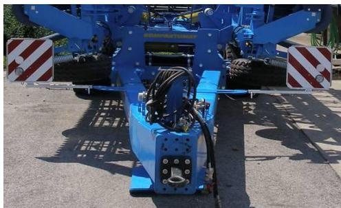
Рис. 18 - размещение задних предохранительных щитков
