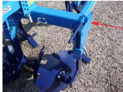
Abb. 4 - hintere, doppelte Walze in Arbeitslage
