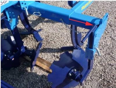
Abb. 3 - seitliche, Ausrückbare Scheiben in Transportlage
