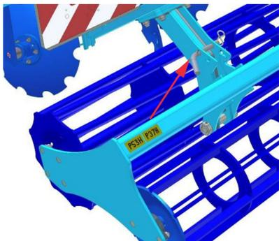
Abb. 5 - hintere, doppelte Walze in Transportlage
