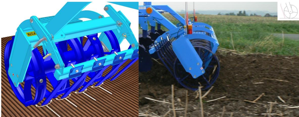
2. Die vorderen Planierzinken, zwischen die Walzenräder platziert, werfen die Erde in die Räder. Die Klumpen werden also teilweise unter den Rädern zerbröckelt und teilweise innerhalb der Räder zerkleinert. Bei einer solchen Einstellung ist die Oberfläche nach der Arbeit durch eine feine Erdschicht bedeckt.
