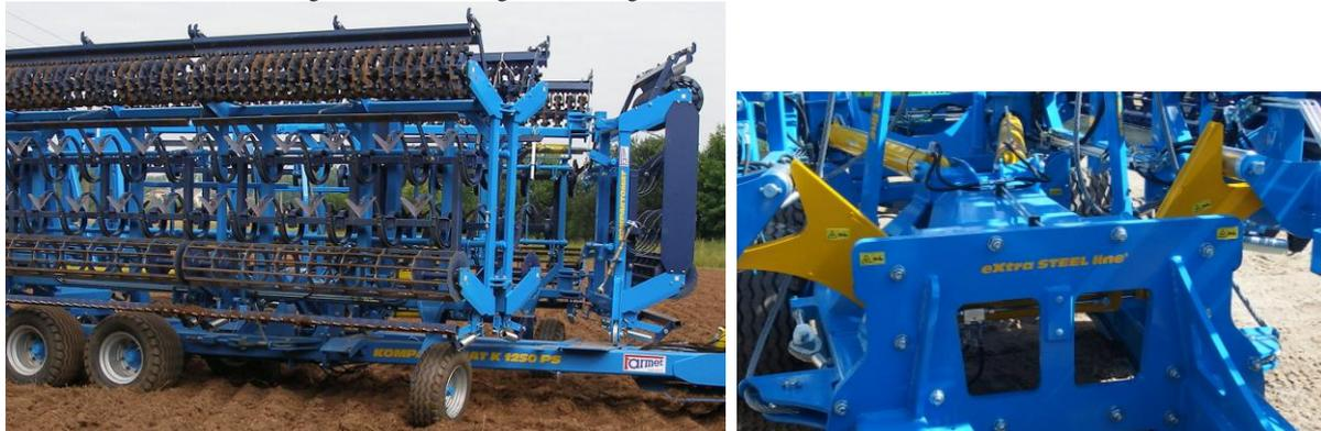
**8.5.** Sichern Sie nach dem Klappen der Maschine in die Transportposition die Seitenrahmen durch die Verbindungsstange und platzieren Sie die Sicherheitsschilder in die Lage für den Transport auf Verkehrsstraßen.
