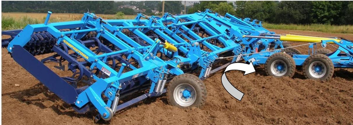
Abb. 15 - Schließen der Arbeitssektionen in die Transportposition
