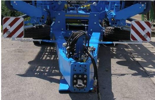
Abb. 18 - Platzierung der hinteren Sicherheitsschilder
