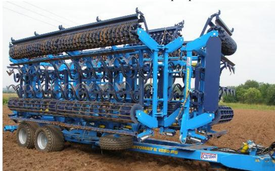
Abb.10-Die Hilfsräder sind zum Aufklappen vorbereitet
