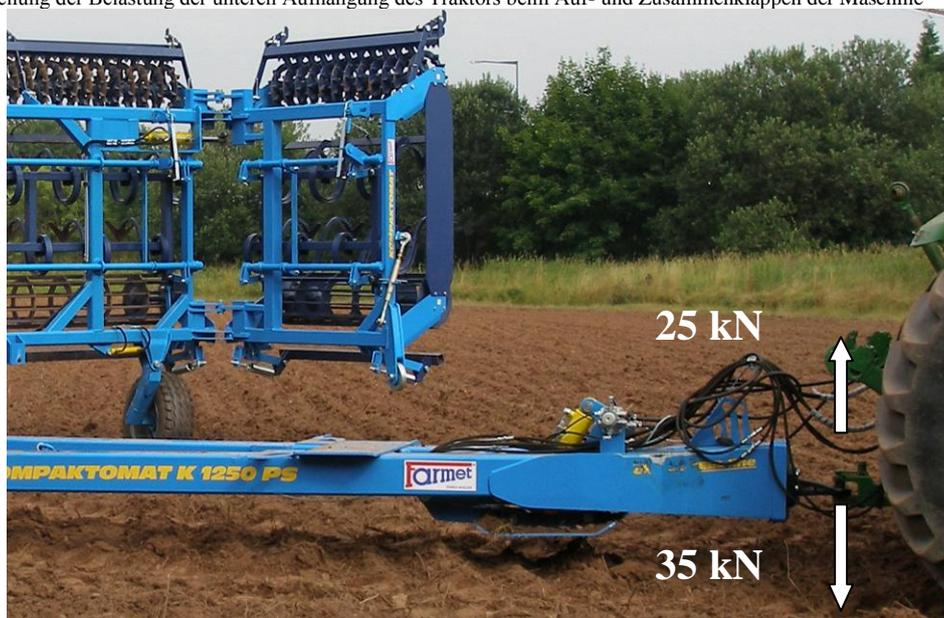
**7.2** Demontieren Sie vor dem Aufklappen die Warnscheibe und befestigen Sie sie an den Ablagebefestigungen an der Deichsel. Klappen Sie die Maschine auf einer ausreichend großen und ebenen Fläche auf und zu. Falls Sie sich auf einem leichten Hang befinden, stellen Sie das Zugsystem so, dass die Fahrtrichtung hangaufwärts zeigt. Beim Zusammenklappen muss der Traktor und auch die Maschine gebremst sein und es darf nicht zu einer Bewegung des Zugsystems kommen!
