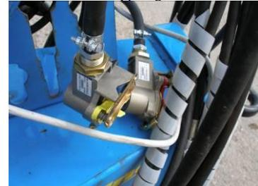
Abb.28-Detail der Beschreibung der Ventilbedienung der Bremsen
