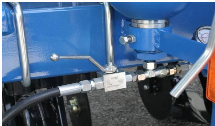
Rys. 13. Zawór docisku hydraulicznego w pozycji otwartej
