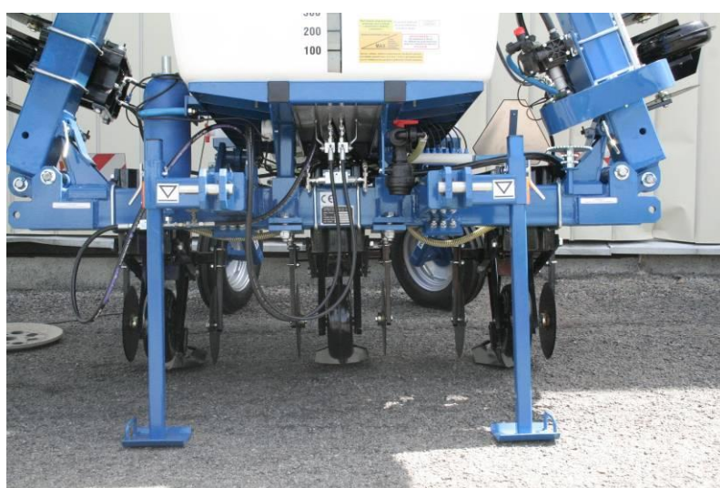
Rys. 8. Podpory parkingowe w pozycji złożonej
