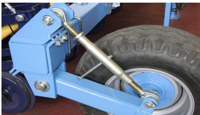
Rys.11. Regulowana śruba przedniego koła jezdnego
