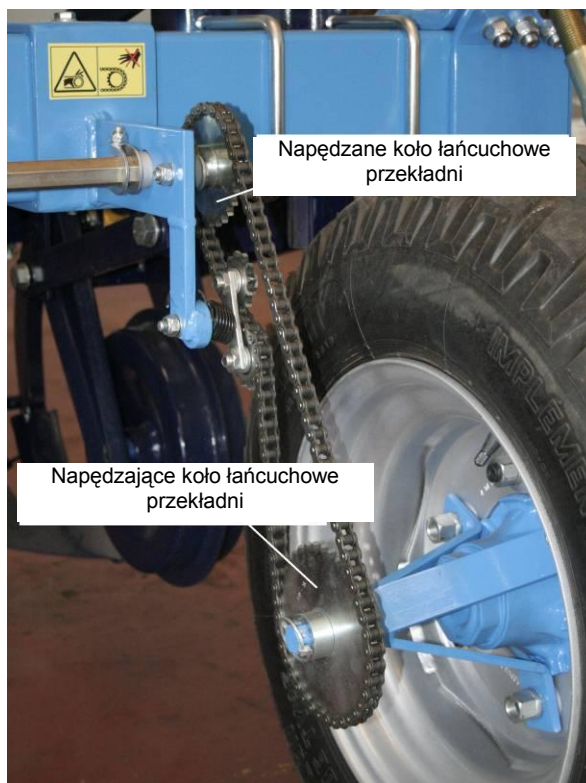
Rys. 4. Przenoszenie łańcuchowe przekładni
