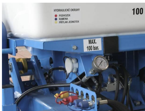
Rys. 7. Podłączenie układów hydraulicznych
