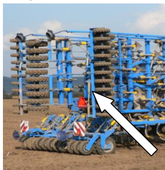
рис. 8 - раскладывание боковых катков
