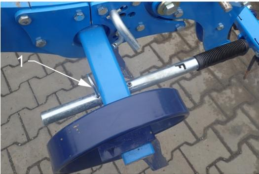
1 – Удалить пружинный штифт и вытянуть рычаг из посадочного места
