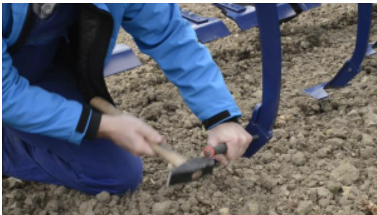
С помощью подготовленных инструментов выбиваем пружинный штифт и после этого лапу можно стянуть со стойки.
