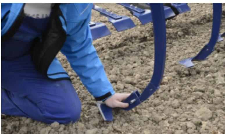
На стойку насаживаем новый рабочий орган и далее фиксируем пружинным штифтом 12x50 мм.
