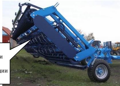
рис. 31 - положение рабочей секции для замены лап в поле
