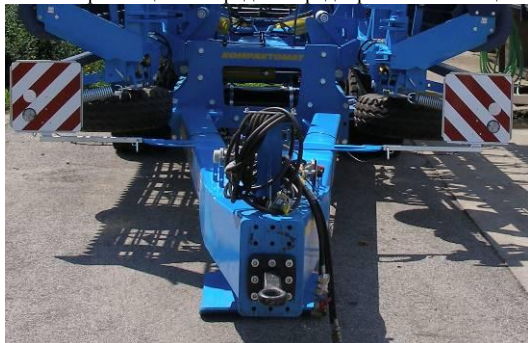
Рис. 17 - размещение передних предохранительных щитков
