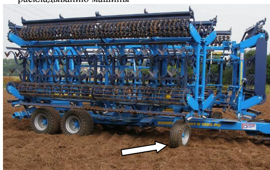
Рис. 10 - вспомогательные колёса подготовлены к раскладыванию машины
