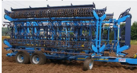
рис. 30 - машина в транспортном положении для замены лап
