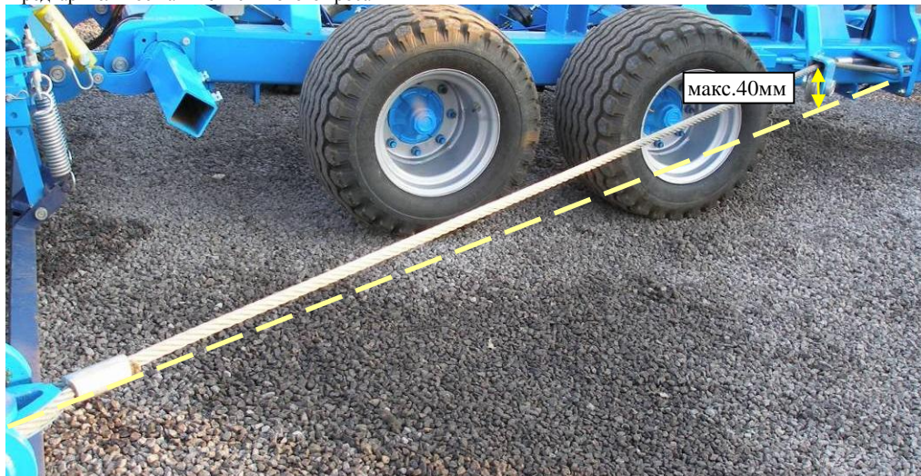
Рис. 24 - предварительное натяжение тягового троса
