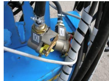
рис. 27 - быстроразъёмные муфты тормоза
