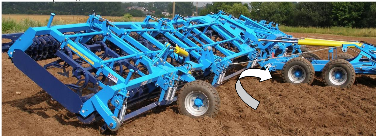
Рис. 15 - закрытие рабочих секций в транспортное положение
