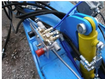
рис. 26 - вентиль управления ручного тормоза
