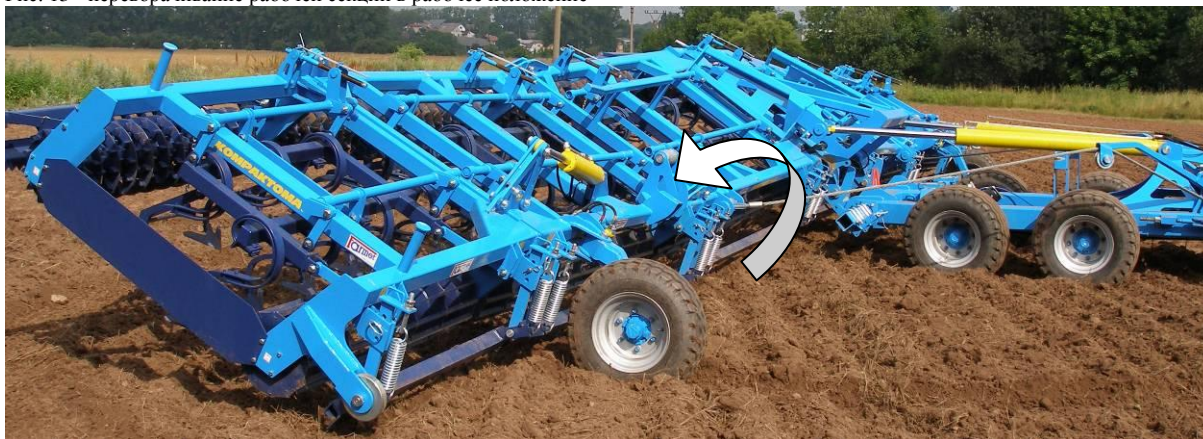
Рис. 13 - переворачивание рабочей секции в рабочее положение
