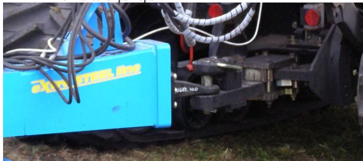
рис. 5 - подключение машины к нижней навеске трактора
