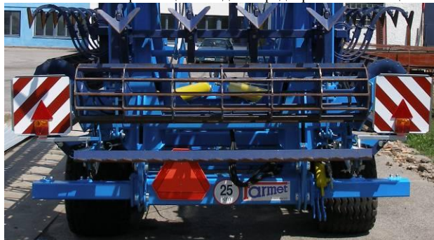
Рис. 18 - размещение задних предохранительных щитков
