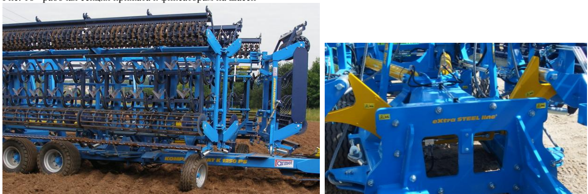
Рис. 16 - рабочая секция прижата к фиксаторам на шасси
