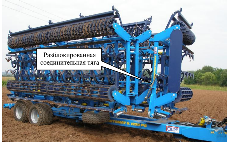
Рис. 7 - машина K 1570 PS перед началом раскладывания
