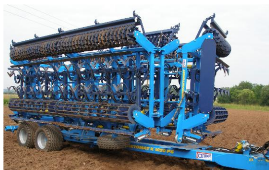
Рис. 9 - вспомогательные колёса в транспортном положении
