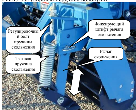
Рис.19-Регулировка передней волокуши
