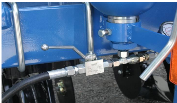
Рис. № 13 Клапан гидравлического прижатия в открытом положении
