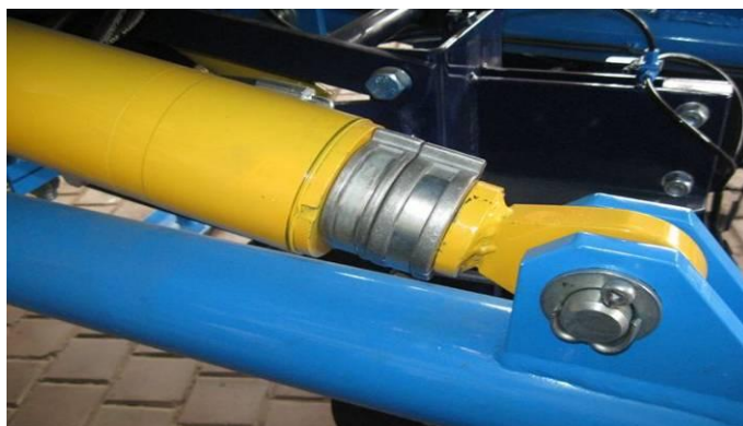
Рис. 12 Ограничительные шайбы цилиндров шасси
