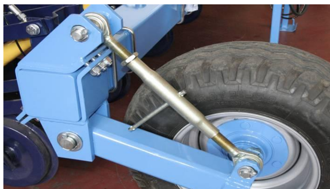
Рис. 11 Регулировочный болт переднего ходового колеса
