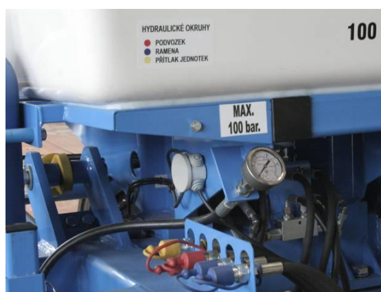
Рис. 7. Подсоединение гидравлических контуров
