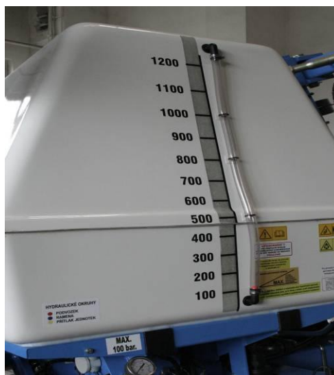
Рис. 1 Резервуар для удобрений с указателем уровня
