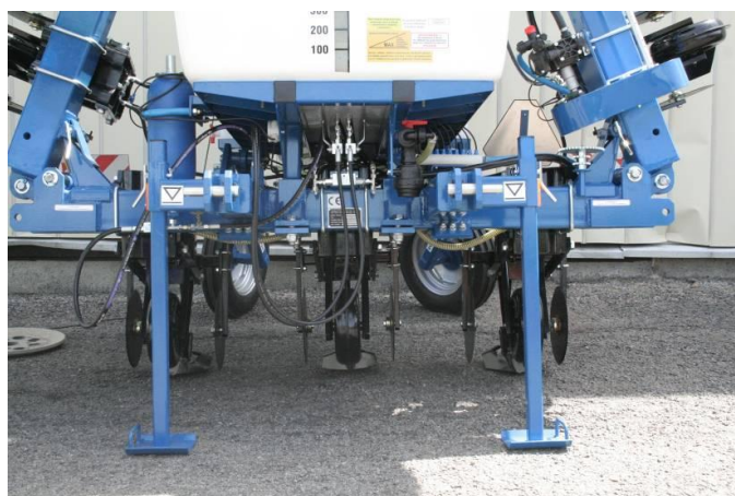
Рис. 8. Опорные ножки машины в сложенном положении
