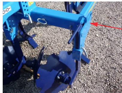
Рис.6 - задний двойной каток в трансп. положении
