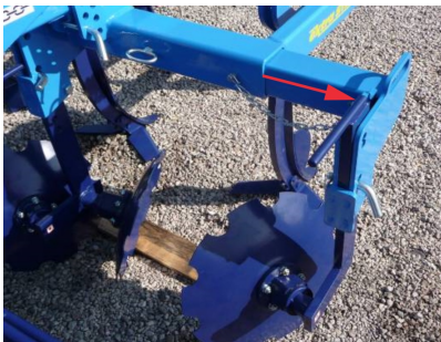
Рис.5 - задний двойной каток в рабочем положении
