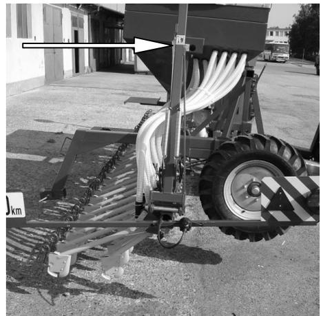
¡No use los orificios de montaje para levantar la sembradora!
