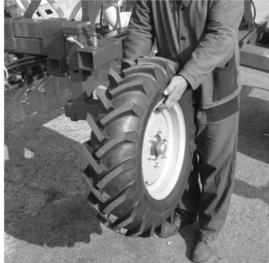
4. Desbloquear la rueda derecha, sacar, Introducir en el orificio y bloquear
