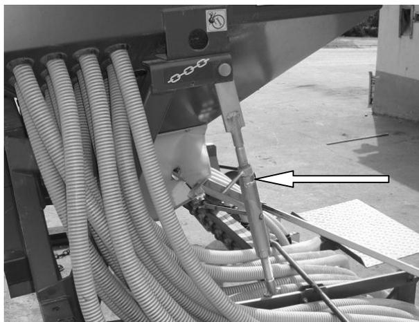
Fig. 25 tornillos de tendido del paralelogramo
