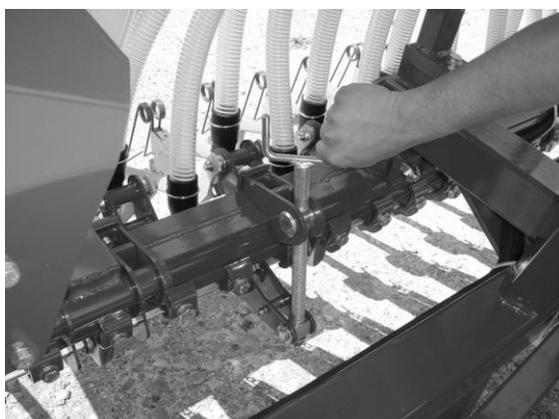
**Fig. 3** ajuste central de la presión adicional en las zapatas de siembra
