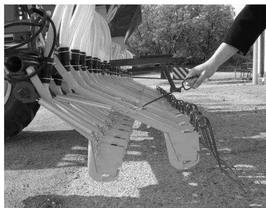
**Fig. 4** cambio individual de la presión adicional en las zapatas de siembra
