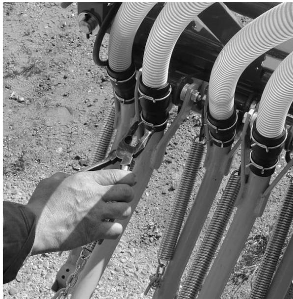
Fig. 24 montaje de conductos de la simiente
