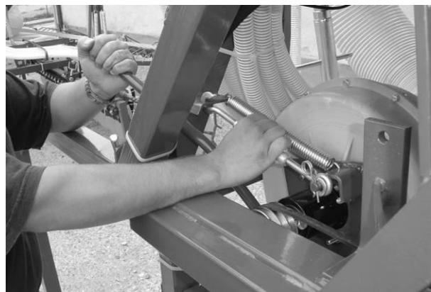
Fig. 22 Puesta de correas trapezoidales, MB
