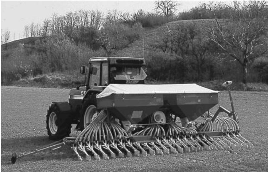
Fig. 13 La sembradora MD con la anchura de trabajo 6 m
