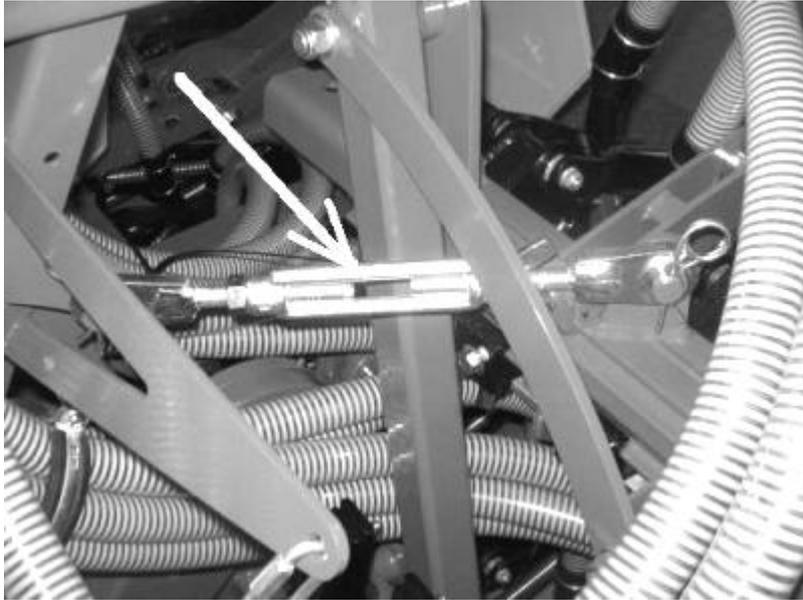
**Fig. 12a** Bloqueo de las partes abatibles en la posición de transporte
