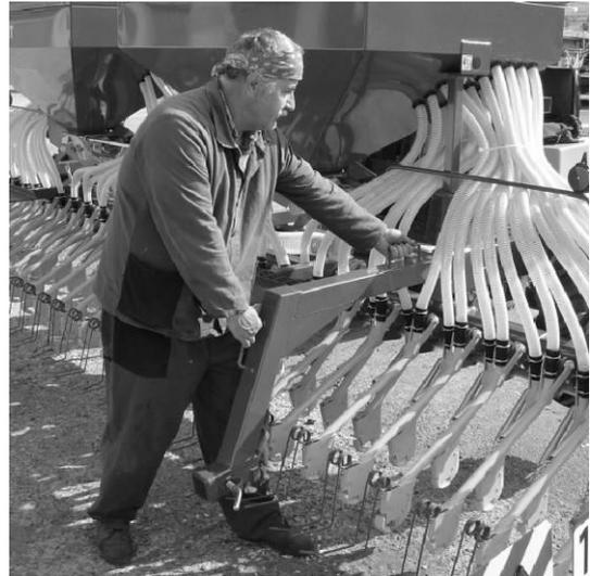
7. Poner el árbol de accionamiento y asegurarlo con el acoplamiento de muelle 8. Desbloquear el eje y sacarlo
