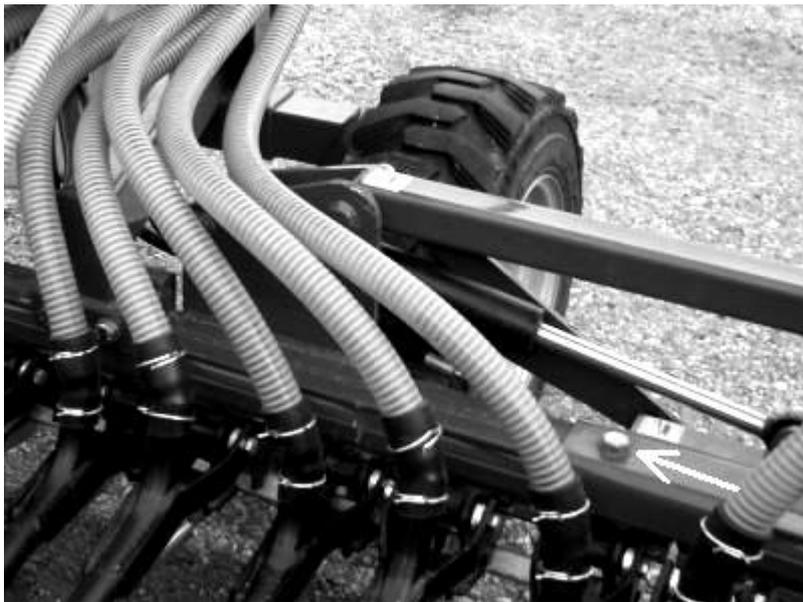
**Fig. 12b** Bloqueo de las partes abatibles en la posición de trabajo
