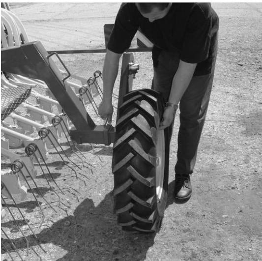
1. Desbloquear la rueda izquierda con el accionamiento, sacar, Trasladar la rueda al lado del eje
