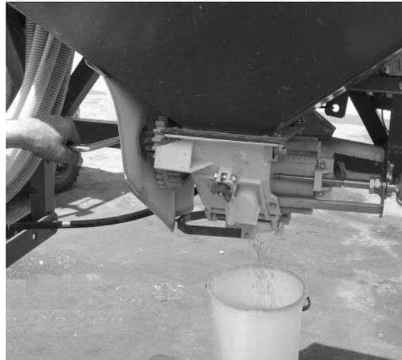
Fig. 7 calibrado de la sembradora
