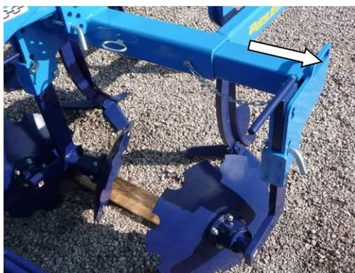
Fig.4 – discos móviles laterales en la posición de transporte
