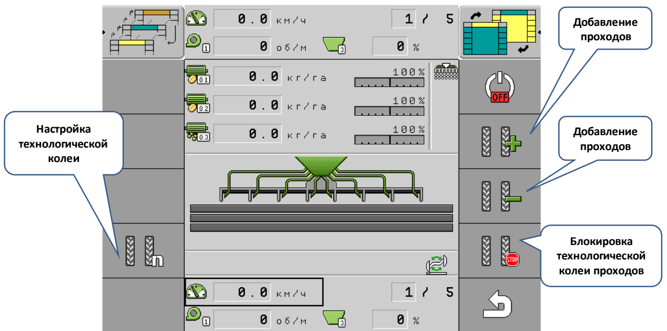
Рис. 18 - Настройка технологической колеи
