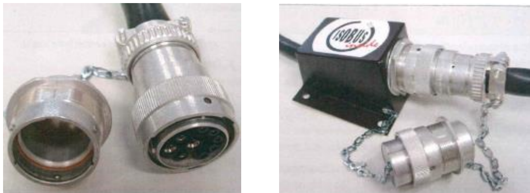
рис. 4 - розетка подключения на дышле машины
