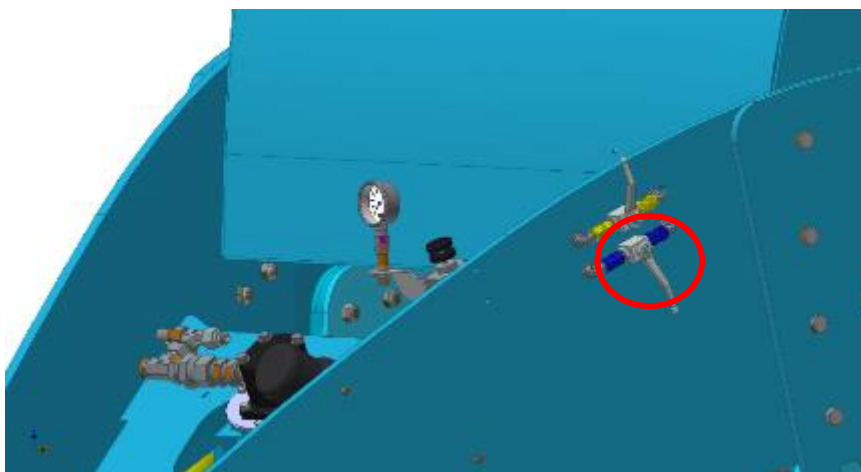
Рис. 30 - Закрытие вентиля складывания
