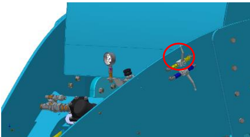
Рис.32 – желтый шаровой клапан передней секции поз. ЗАКРЫТО
