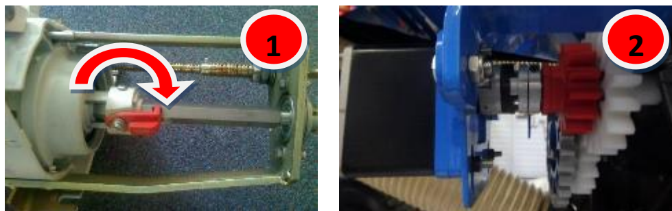
Рис. 34 – Настройка турникета дозатора
