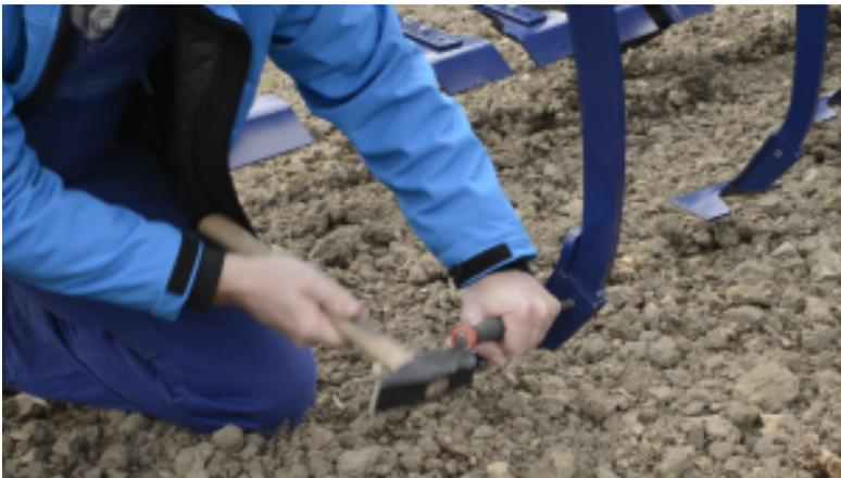
S pomocí připraveného dílenského vybavení vyrazíme pružný kolík a poté je radlici možné stáhnout ze slupice.
