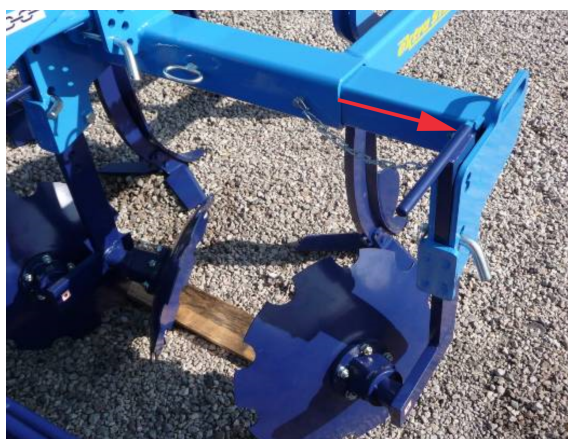
Rys. 3 - boczne wysuwne dyski w pozycji roboczej
