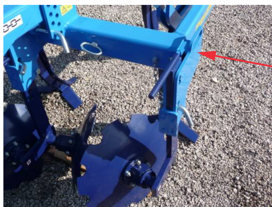
Rys. 6 - tylny podwójny walec w pozycji transportowej
