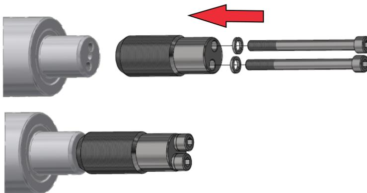
2. Mise en place du palier + rondelle et vissage du corps du dispositif
