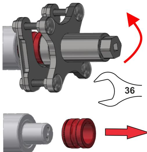
**13.1.1.3 Montage des paliers sur les axes**
