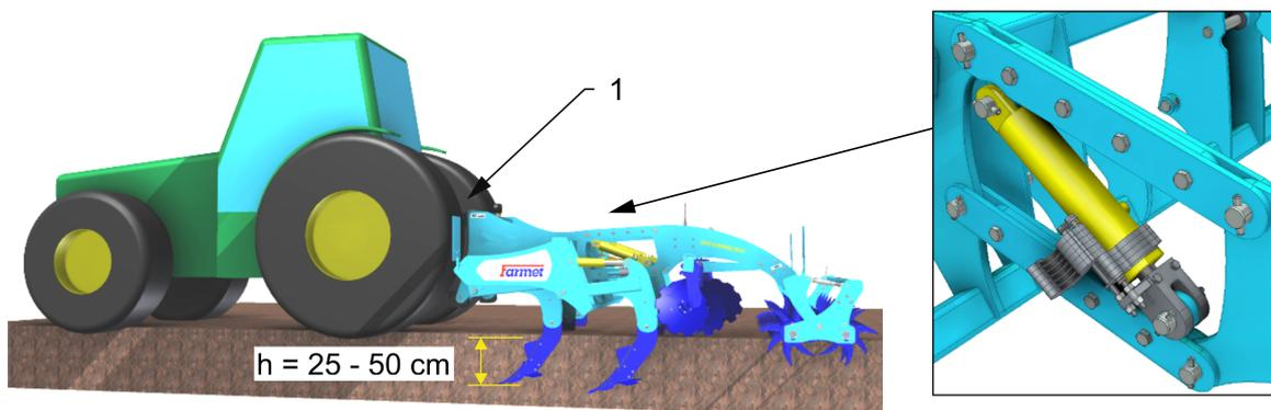
1 – 3 point TBZ – réglage du plan longitudinal
