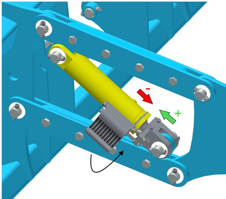
1. Levez la machine au niveau de l'attelage du tracteur et abaissez les rouleaux à l'aide des tiges de piston jusqu'à la position maximale inférieure (tiges de piston sorties). Réglez le nombre adéquat de cales de délimitation sur les tiges de piston des rouleaux.
