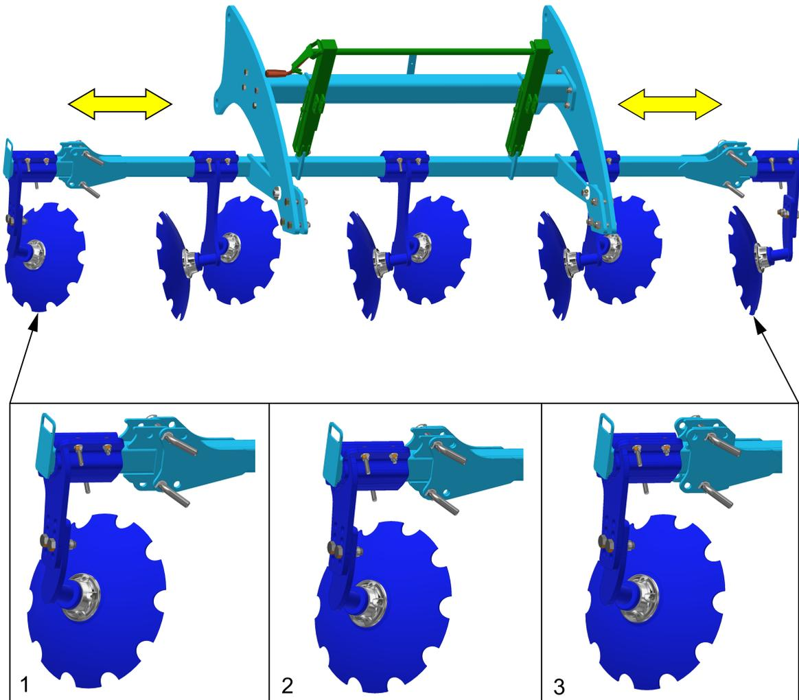
Fig. 7 - Disques niveleurs latéraux réglables en hauteur
