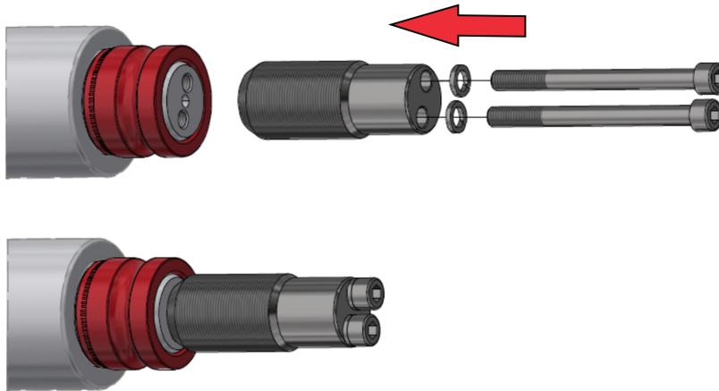
2. Vissage du corps du dispositif, mise en place de la pièce pour le démontage du palier, mise en place de la pièce pour le démontage de la bague et fixation à l'aide des écrous
