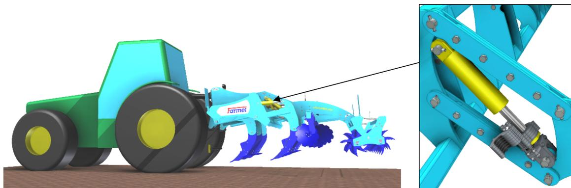
2. Placez les tiges de piston à la position supérieure maximale (tiges de piston rentrées), de façon à ce que les cales de délimitation placées sur ces tiges de piston soient fermement serrées. Vous pouvez enfoncer lentement la machine dans le sol jusqu'à ce qu'elle repose sur le rouleau arrière. Réglez le plan longitudinal de la machine par la position des bras inférieurs du tracteur, ce qui permet d'assurer la même profondeur de travail de la première et de la deuxième rangée de socs.
