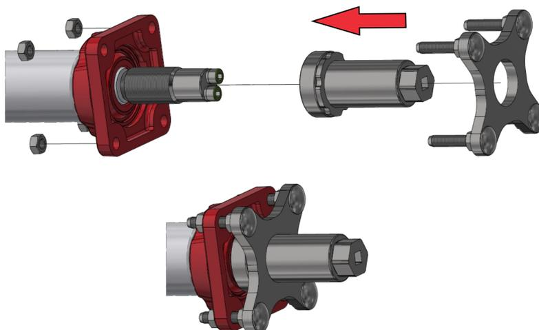
3. Démontage du palier en vissant le corps du dispositif à l'aide de la clé 36
