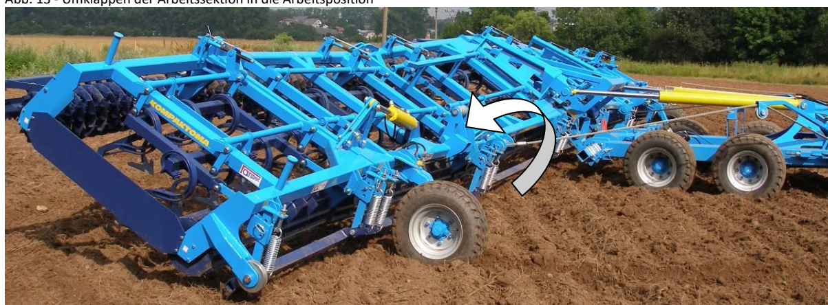
Abb. 13 - Umklappen der Arbeitssektion in die Arbeitsposition
