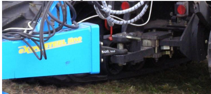
Abb. 5 - Anbindung der Maschine an die untere Aufhängung des Traktors
