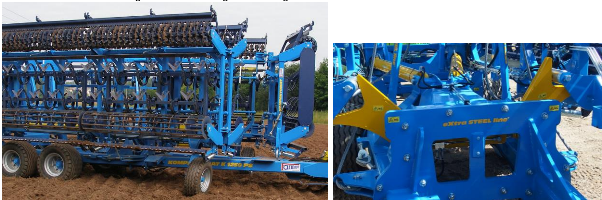
Abb. 16 - Die Arbeitssektion liegt auf den am Untergestell befestigten Rasten auf
