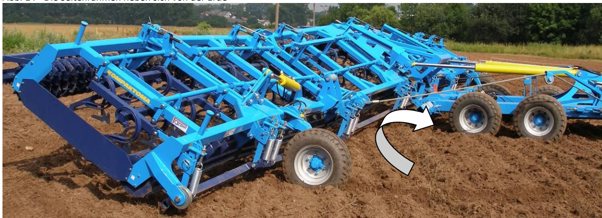
Abb. 14 - Die Seitenrahmen heben sich von der Erde
