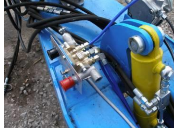
Abb.28-Detail der Beschreibung der Ventilbedienung der Bremsen
