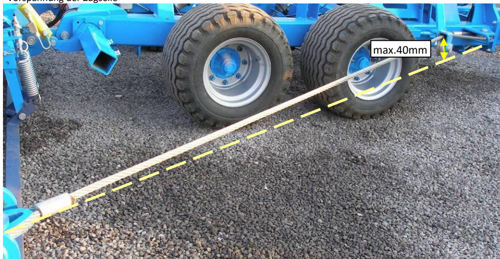
Abb. 24 - Vorspannung der Zugseile
