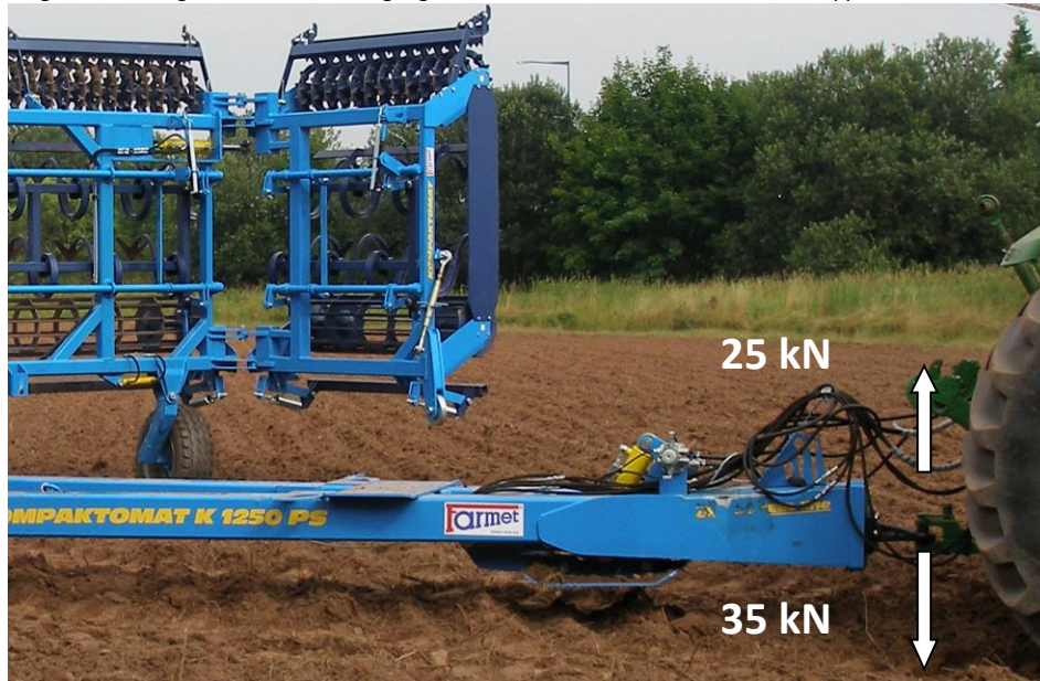
Abb. 6 - Darstellung der Belastung der unteren Aufhängung des Traktors beim Auf- und Zusammenklappen der Maschine
