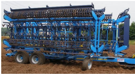
Abb.30- Maschine in der Transportposition für den Austausch der Schmalschare
