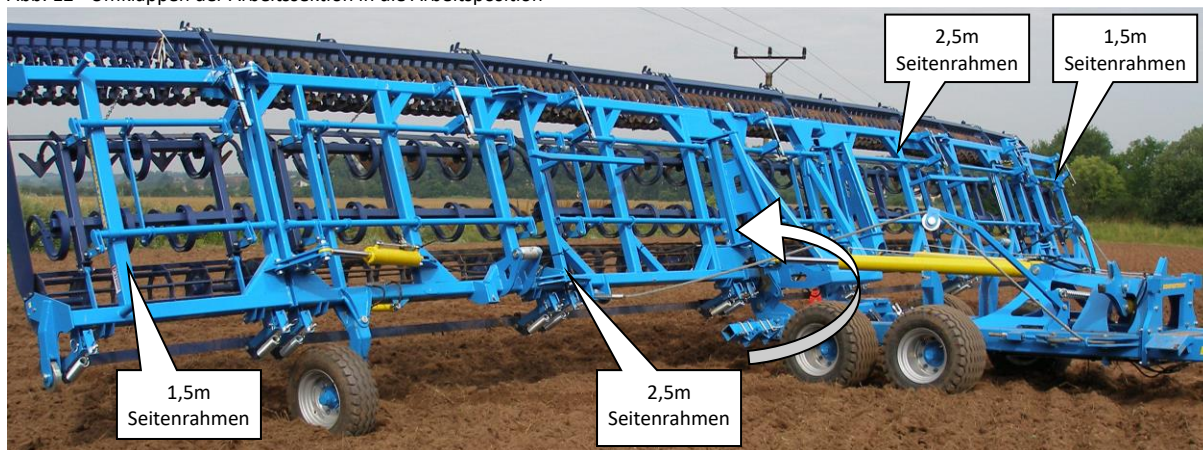
Abb. 13 - Umklappen der Arbeitssektion in die Arbeitsposition
