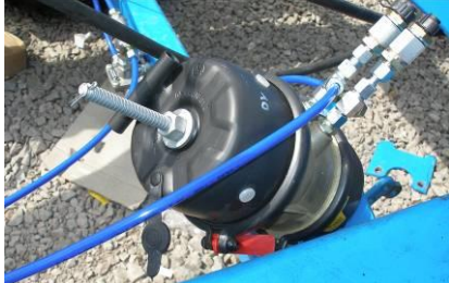
Abb.28-Detail der Beschreibung der Ventilbedienung der Bremsen
