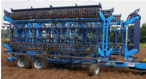
obr.30- stroj v transportní poloze pro výměnu radliček
