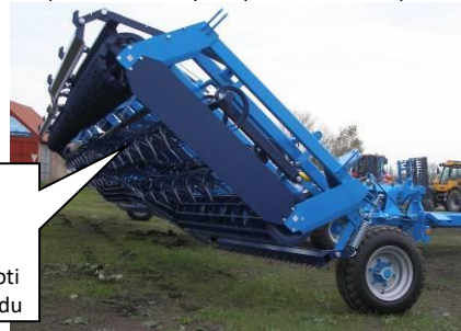
obr.31-poloha pracovní sekce pro výměnu radlic na poli
