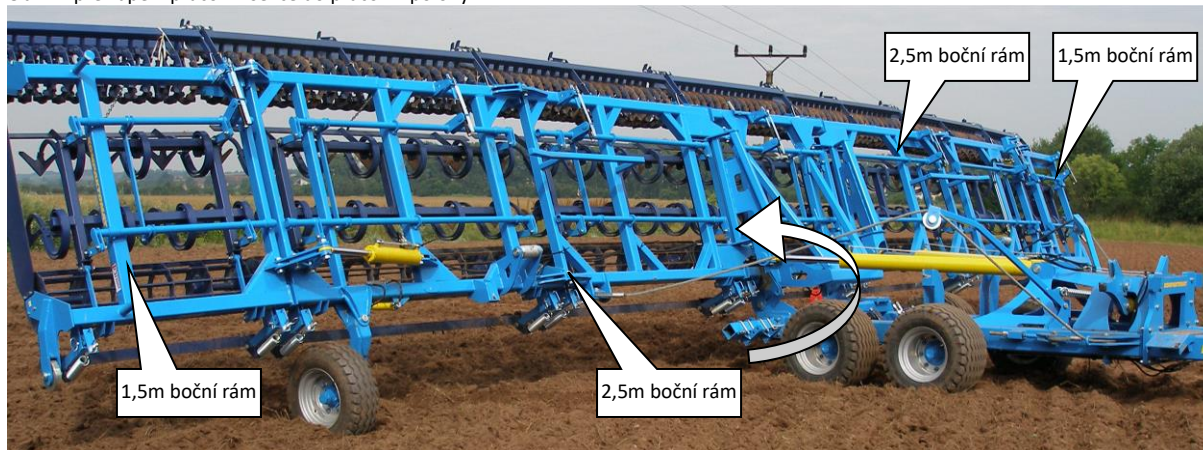
Obr.13-překlápění pracovní sekce do pracovní polohy
