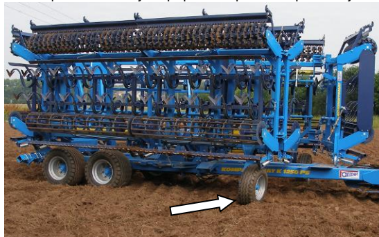
Obr.10-pomocná kola jsou připravena pro rozklápění stroje
