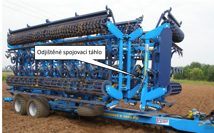
Obr.7-stroj K 1570 PS před zahájením rozklápění
