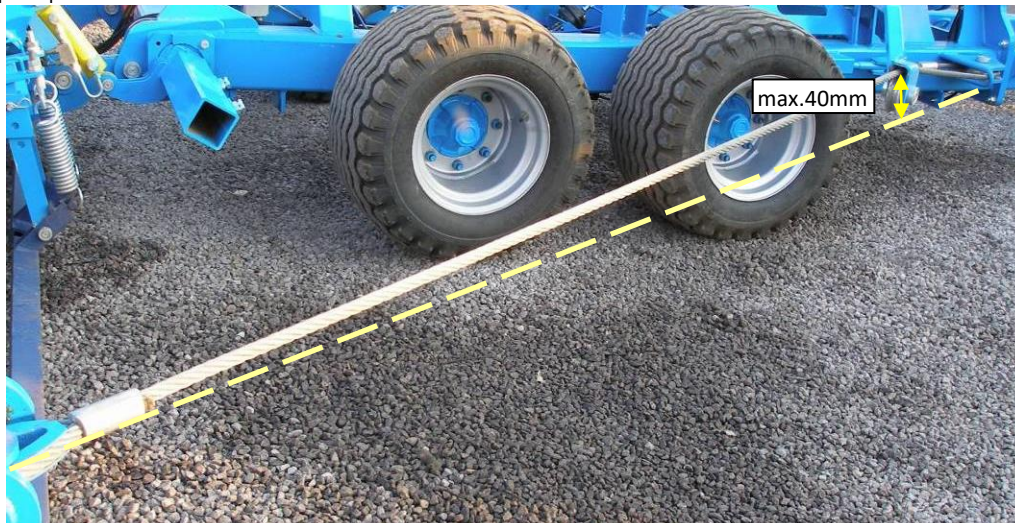
Obr.24-předepnutí tažného lana
