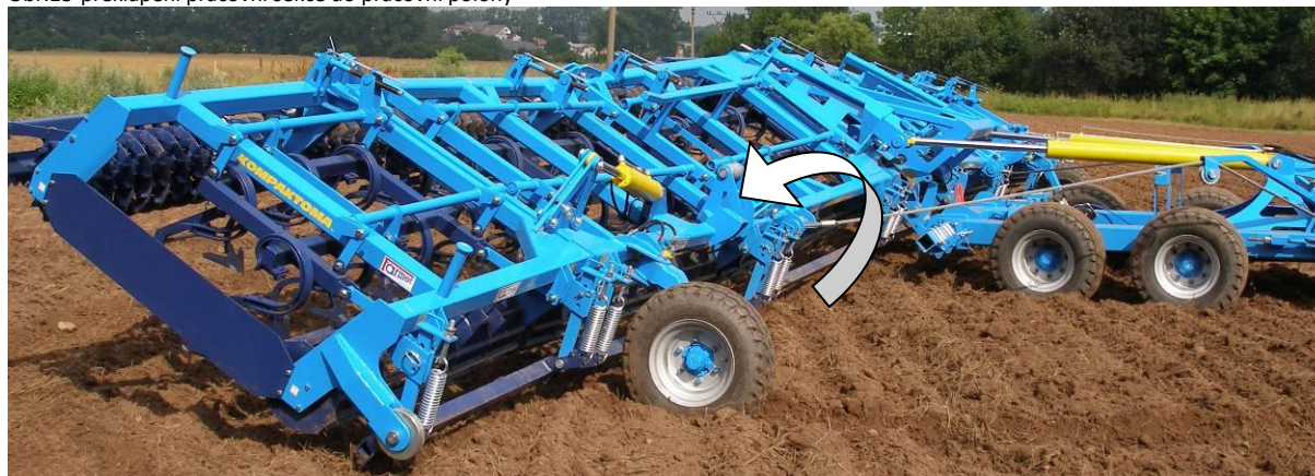
Obr.13-překlápění pracovní sekce do pracovní polohy
